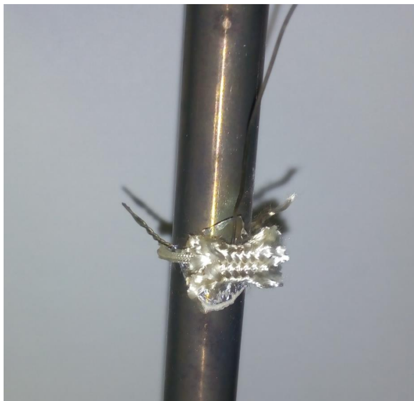
Obrázek č. 9.3: Uchycení termočlánku k testovacímu kanálu
