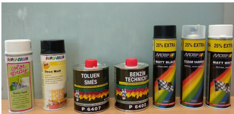
Obr. 3-5 Přípravky použité pro odmašťování a tvorbu patternu
