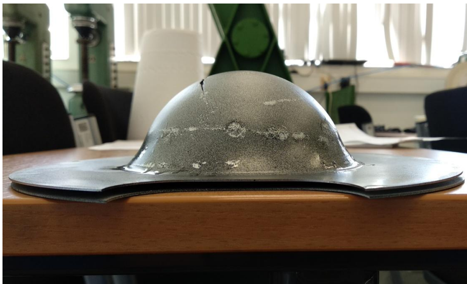
Obr. 5-2 Vizuální porovnání vzorku taženého rychlostí 2 mm/s a 15 mm/s
