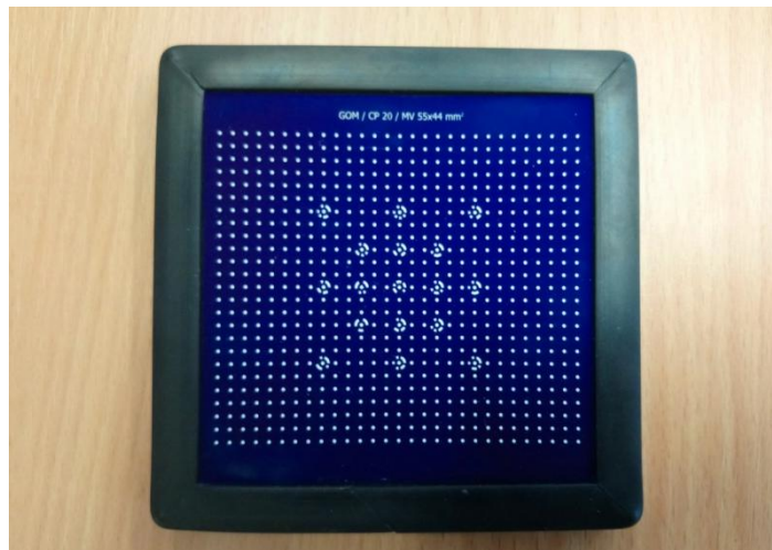
Obr. 3-2 Kalibrační destička GOM/CP 20/MV 55x44 mm 2
