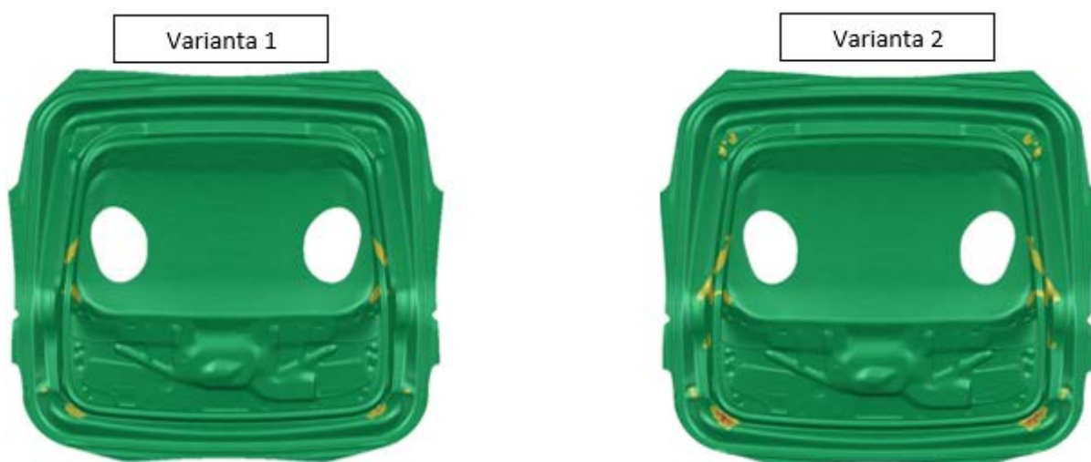
Obrázek 74 - Díl 5E7.827.159 - Vyhodnocení OP20 - Zvlnění - Varianta 1 a 2
