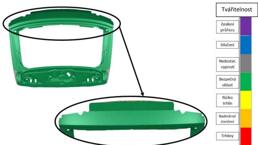
Obrázek 43 - Díl 5E7.827.105 - Vyhodnocení OP40 - Tvářitelnost - Varianta 2
