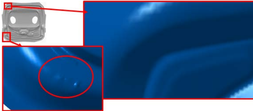
Obrázek 83 - Díl 5E7.827.159 - Srovnání výsledků simulace a reálného výlisku - Vznik zvlnění povrchu na scanu výlisku v OP20
