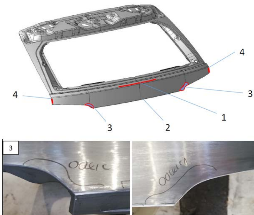
Obrázek 50 - Díl 5E7.827.105 - Srovnání výsledků simulace a reálného výlisku - Auditové závady
