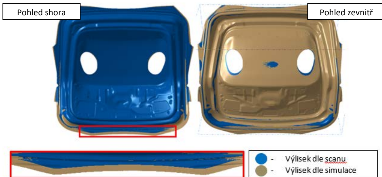
Obrázek 82 - Díl 5E7.827.159 - Srovnání výsledků simulace a reálného výlisku - Vtahy v OP20
