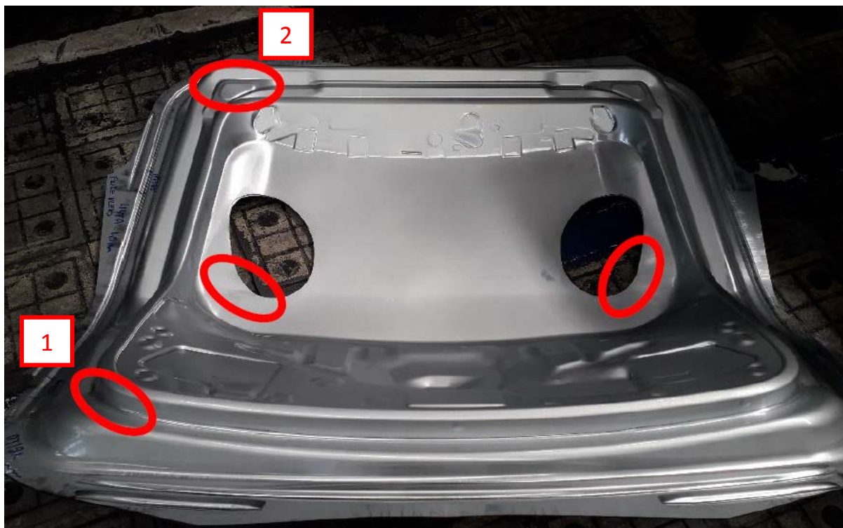
Obrázek 85 - Díl 5E7.827.159 - Srovnání výsledků simulace a reálného vylisku - Vybrané auditové závady
