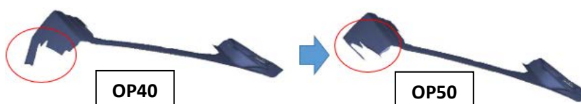
Obrázek 34 - Díl 5E7.827.105 - Metodický postup - OP50
