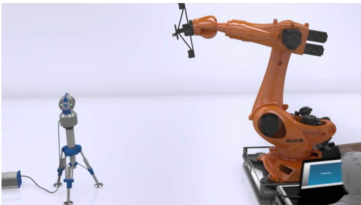
Obrázek 1 Kalibrace robotu pomocí laser trackeru [5]
