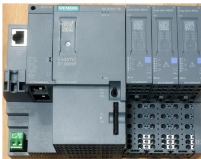
Obr. 51 Připojení karet měření energie s PLC
