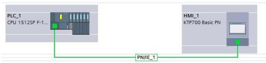
Obr. 52 Přehled propojení stanice Simatic ET200SP a HMI
