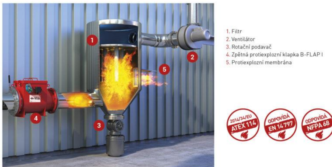
Obr. 2.6. Schéma instalace zařízení pro odlehčení výbuchu na odlučovači prachu od RSBP spol. s.r.o. [5]
