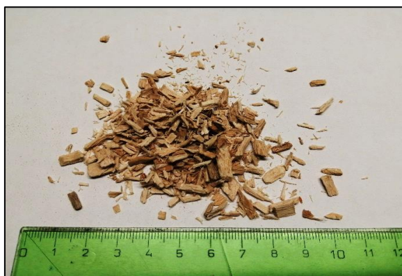
Obr. 25 Buková štěpka po mletí se sítem o velikosti děr 10 mm
