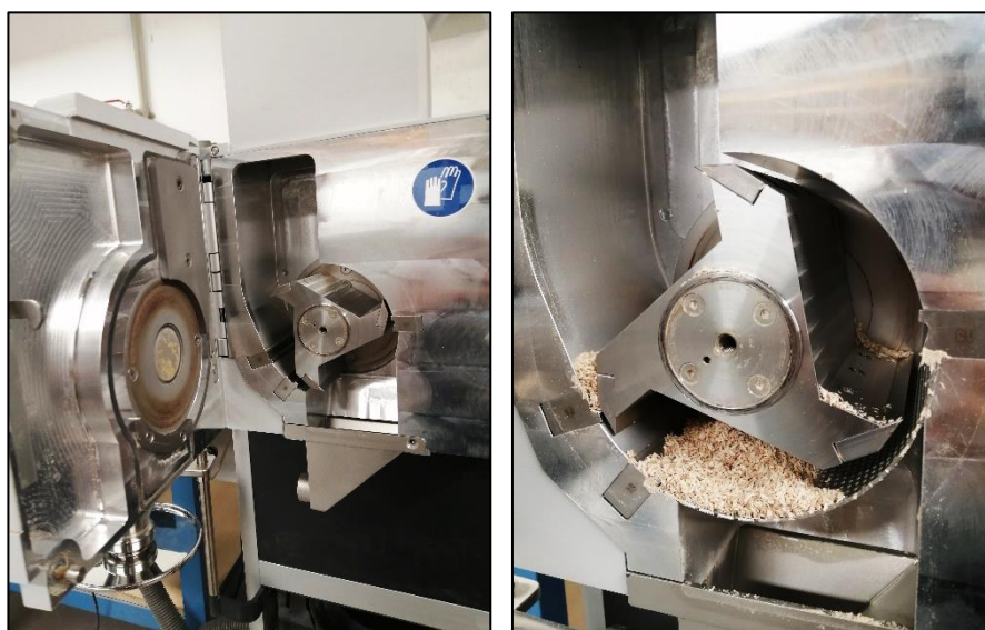
Obr. 27 vlevo : otevřená mlecí komora, vpravo: detail rotoru se zbytkem vstupní štěpky
