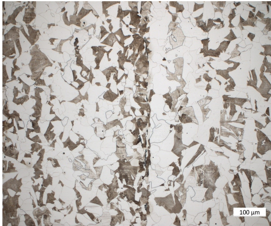
Obrázek 7.16 Mikrostruktura J2 - ZM
