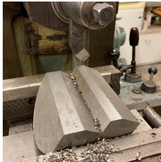
Obrázek 7.2 Příprava svarových ploch
