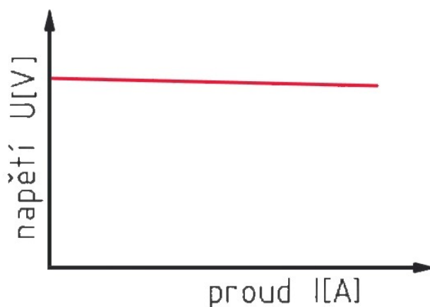
Obrázek 5.3 Charakteristika s konstantním napětím (plochá) [12]
