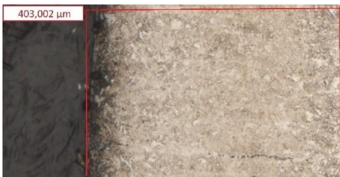
Obrázek 7053 - Střed – rozsah TOO (3D), pozn.: D - delší strana příčného řezu
