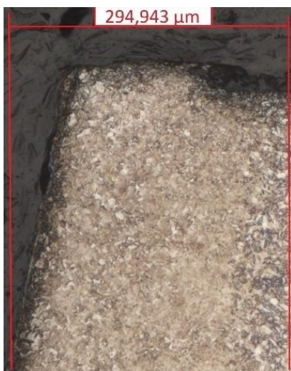
Obrázek 507 - Horní roh – rozsah TOO (3D), pozn.: D - delší strana příčného řezu
