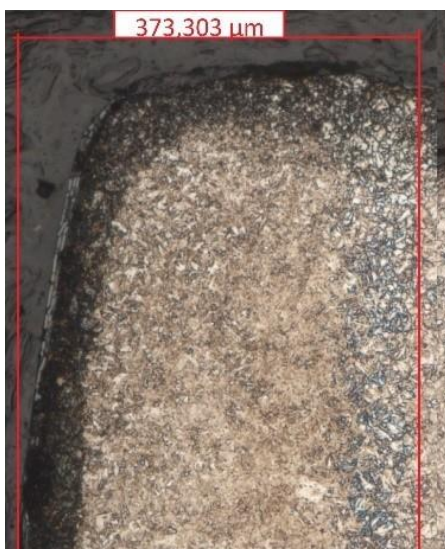
Obrázek 339 - Horní roh – rozsah TOO (1D), pozn.: D - delší strana příčného řezu
