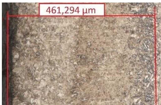
Obrázek 352 - Střed – rozsah TOO (1D), pozn.: D - delší strana příčného řezu
