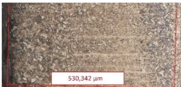
Obrázek 441 - Střed – rozsah TOO (2D), pozn.: D - delší strana příčného řezu
