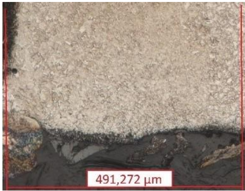
Obrázek 474 - Dolní roh – rozsah TOO (3D), pozn.: D - delší strana příčného řezu
