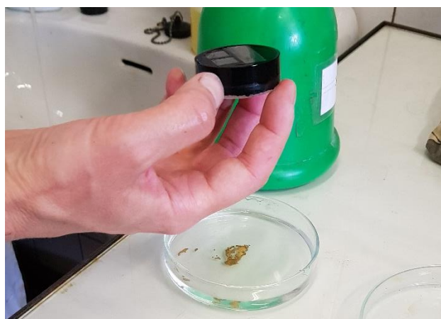
Obrázek 33- Leptání pomocí roztoku Nitalu 4%
