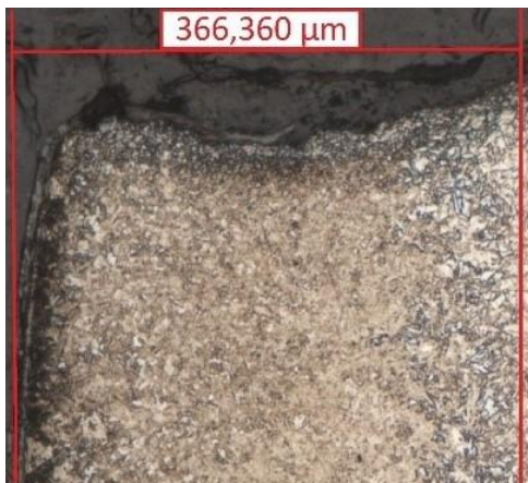
Obrázek 418 - Horní roh – rozsah TOO (2D), pozn.: D - delší strana příčného řezu
