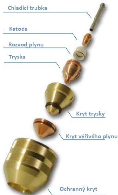
Obrázek 9 - Schéma řezacího hořáku [28]
