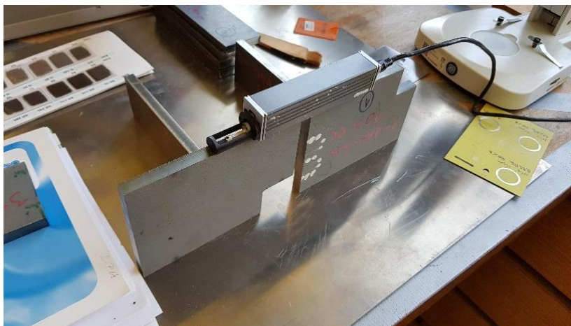
Obrázek 204 - Měření průměrné výšky profilu R_{z5}
