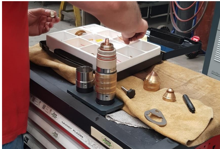
Obrázek 18 - Výměna spotřebních dílů u plazmového hořáku PerCut 451
