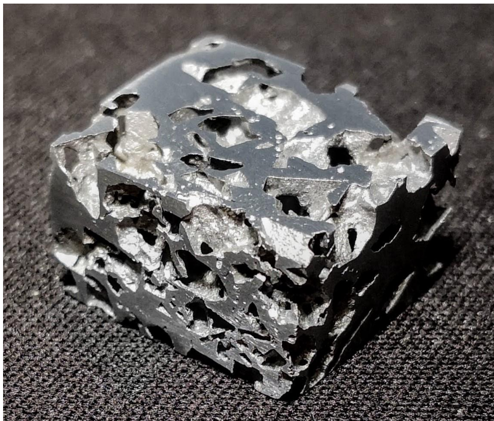
Obrázek 33: Nejúspěšnější odlitek (do soli)
