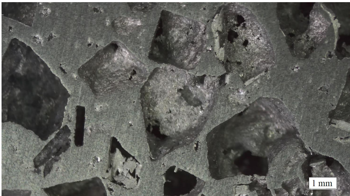
Obrázek 31: Makrofotografie odlitku do soli pod tlakem, menší zrna
