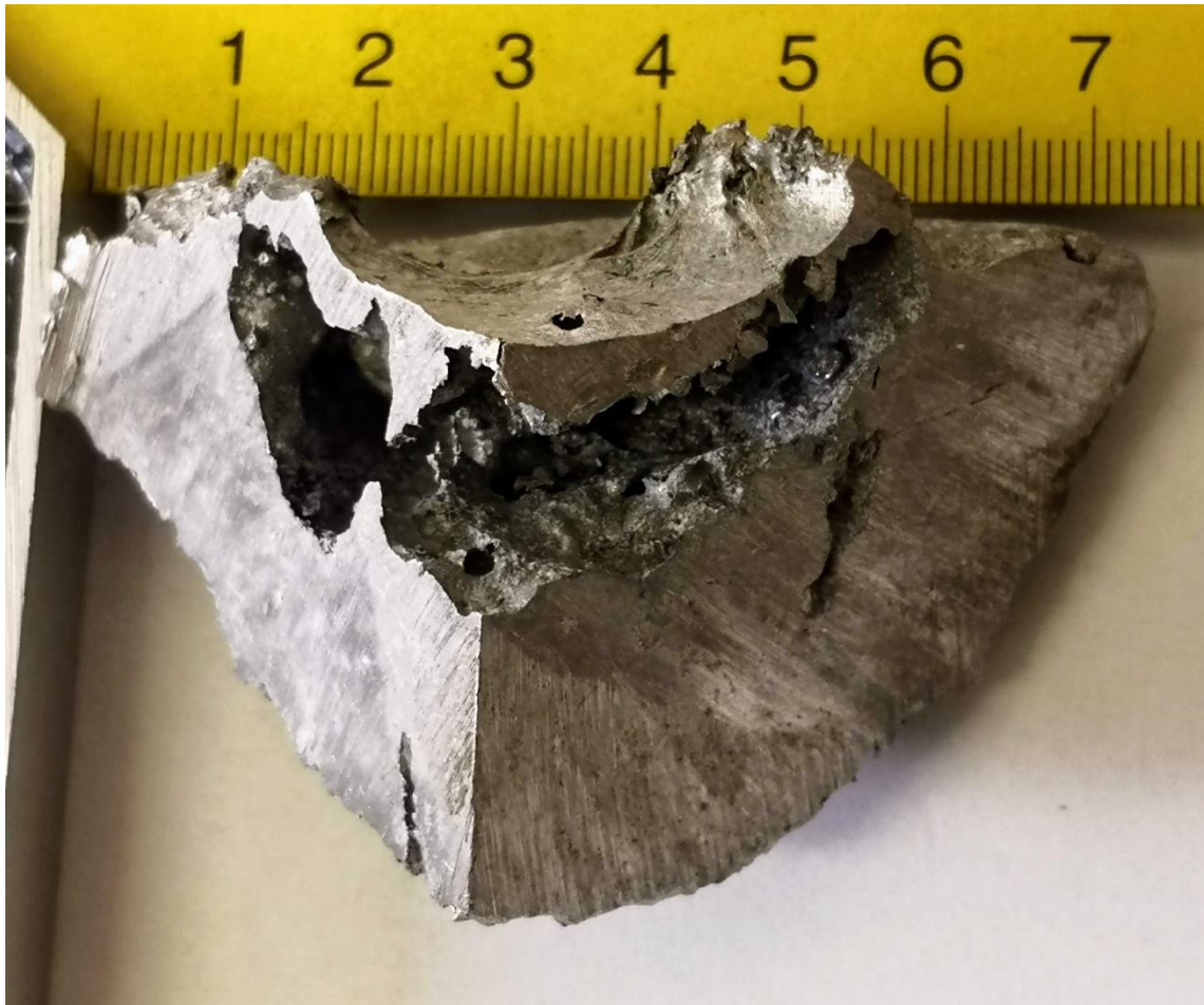
Obrázek 15: Odlitek směsi roztavené soli a hliníku
