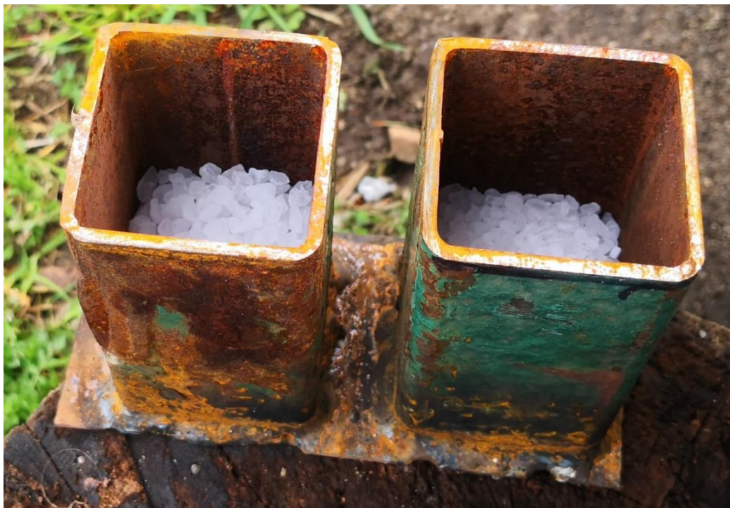
Obrázek 23: Ocelové kokily s velikostí zrna 3-5 mm (vlevo) a 1-3 mm (vpravo)
