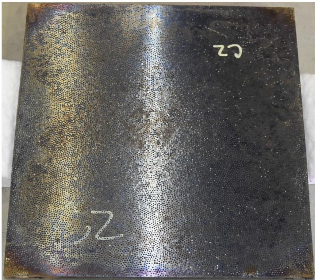
Obrázek 5: Nerezová pěna 30x30 cm zbarvená po teplotním testu [19]
