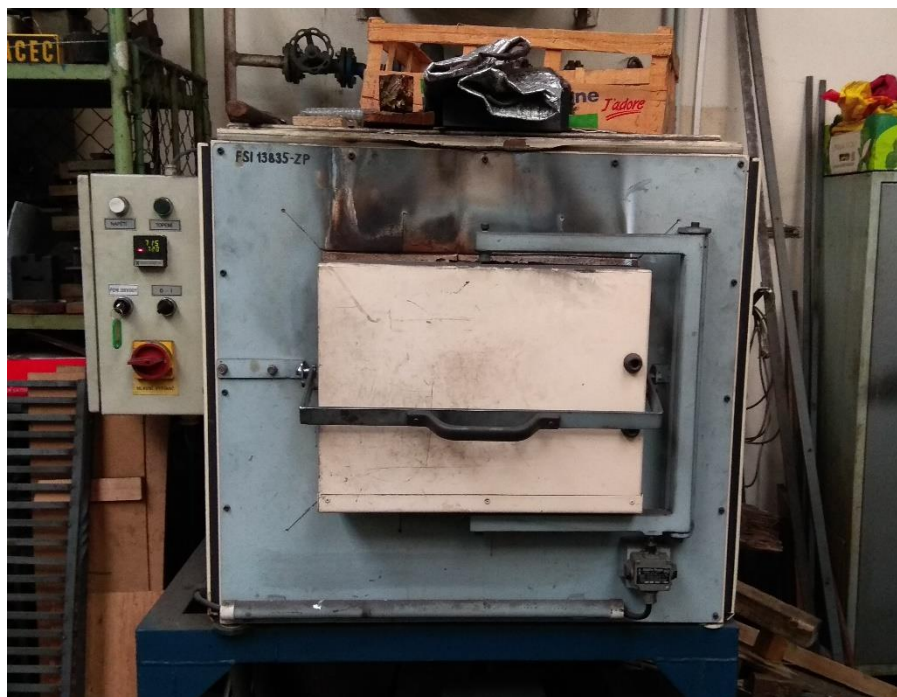
Obrázek 17: Indukční pec použitá u druhého pokusu
