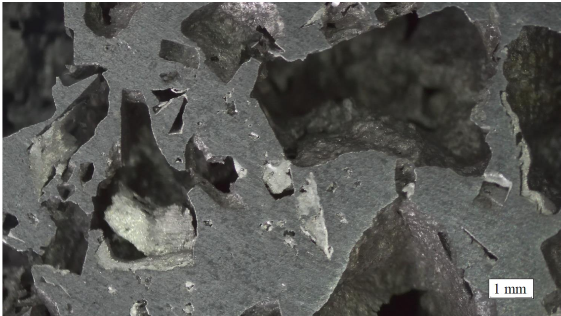
Obrázek 32: Makrofotografie odlitku do soli, větší zrna
