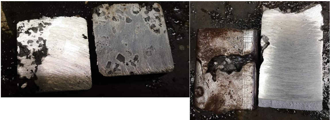
Obrázek 24: Nepovedené odlitky – solná zrna odtlačena na strany (vlevo), rozpadlý odlitek (vpravo)
