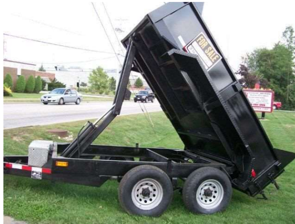
Obrázek 12 – Vlek výrobce M & M Certified Welding co. s alternativním umístěním pákového mechanismu [10]
