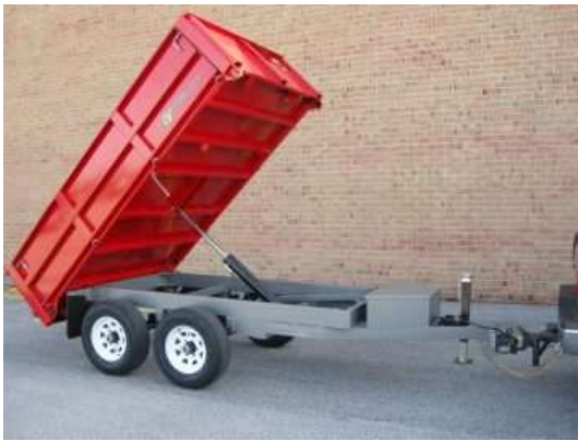
Obrázek 10 – Vlek výrobce BWISE Trailers s jedním hydraulickým válcem [9]
