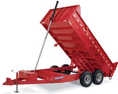
Obrázek 8 – Vlek výrobce Sure-Trac s teleskopickým válcem [8]
