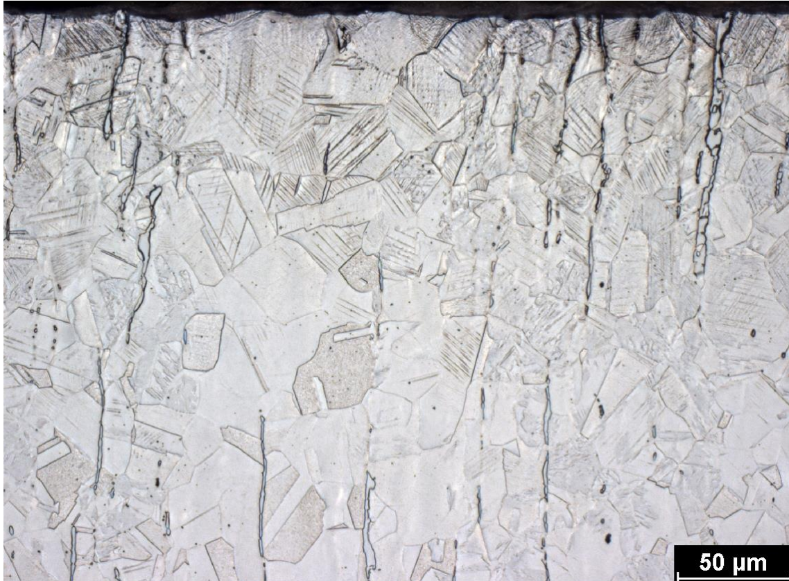
Obrázek 31–Struktura vzorku oceli AISI304 ovlivněné technologií LSP při zvětšení 200x
