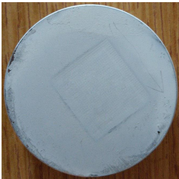
Obrázek 20–Vzorek AISI 304 po ovlivnění technologií LSP před měřením zbytkového napětí
