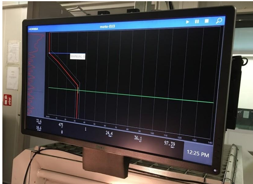
Obrázek 11: Vyobrazení křivky cyklu během testování před vozidlem [autor]
