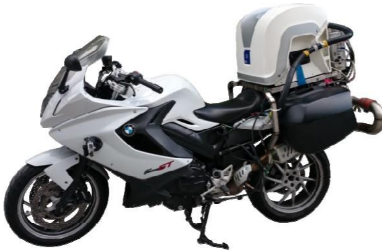
Obrázek 24: Motocykl BMW F 800 GT s PEMSem pro automobily AVL M.O.V.E. [13]
