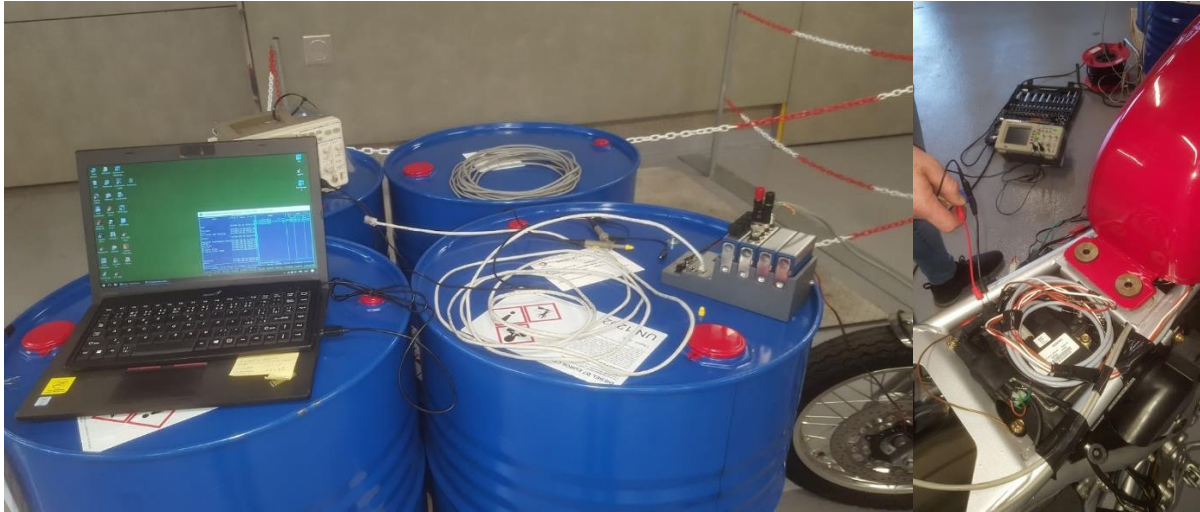
Obrázek 28 a Obrázek 29: Instalace záznamového zařízení na zkoušený motocykl [autor]
