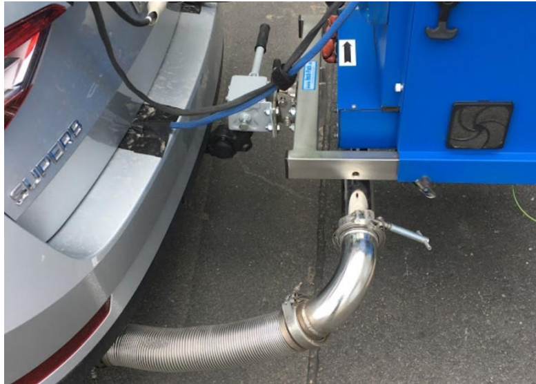
Obrázek 21: Připojení výfuku k průtokoměru PEMSu [autor]
