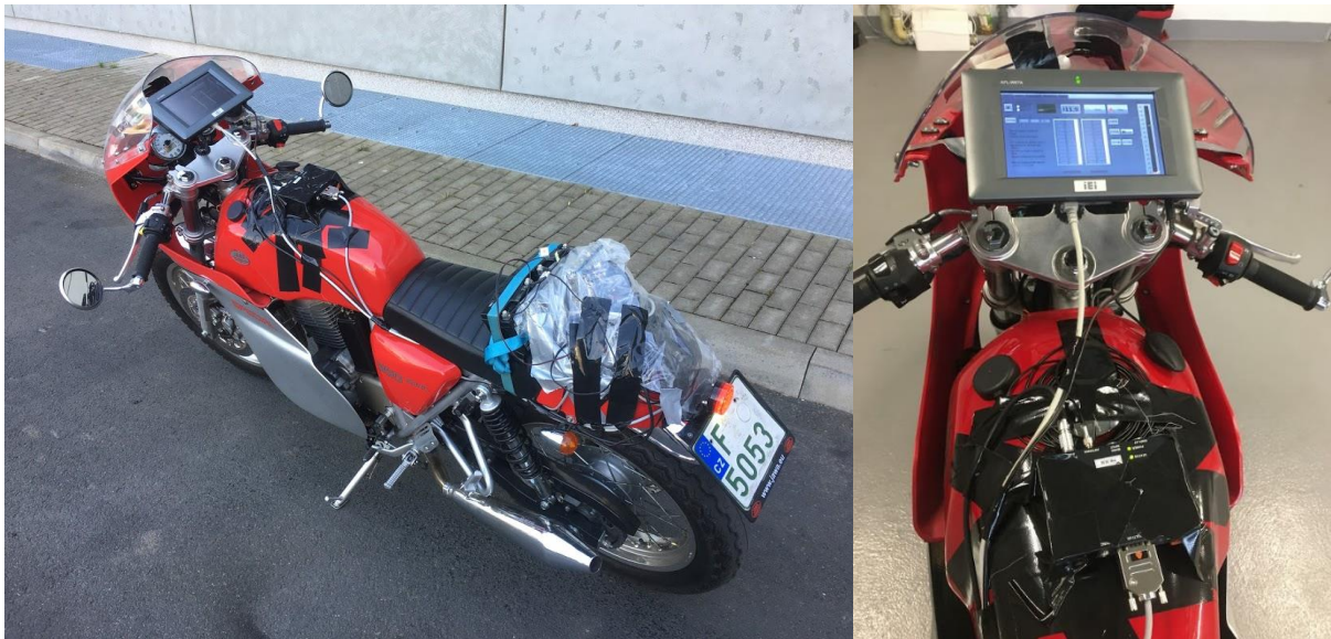
Obrázek 36 a Obrázek 37: Motocykl JAWA se záznamovým zařízením pro dojezdovou zkoušku [autor]
