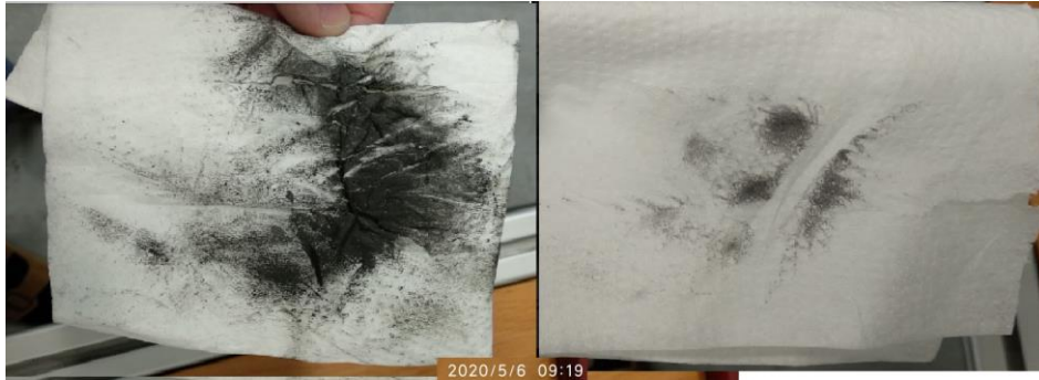
Obrázek 53: Vlevo utěrka po setření nekvalitně připraveného vzorku, vpravo téměř čistá utěrka po otření dobře odmaštěného povrchu
