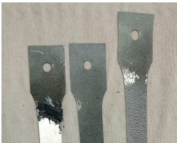
Obrázek 24: Porovnání kvalitně naneseného patternu (vzorek uprostřed) a nekvalitního patternu (vzorky po stranách)
