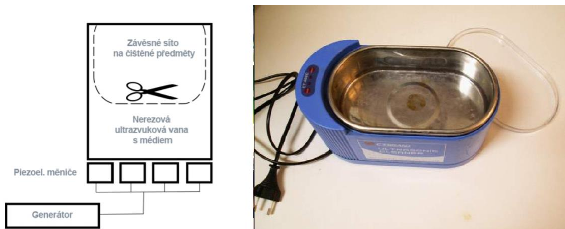
Obrázek 50: Schéma ultrazvukové čističky (vlevo), ultrazvuková čistička (vpravo) [43]
