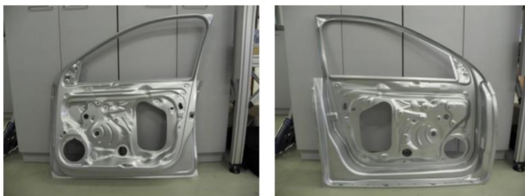
Obrázek 44: Vylisek dveří pro automobil Škoda Rapid: Vlevo vnitřní strana, vpravo vnější strana dveří [47]
