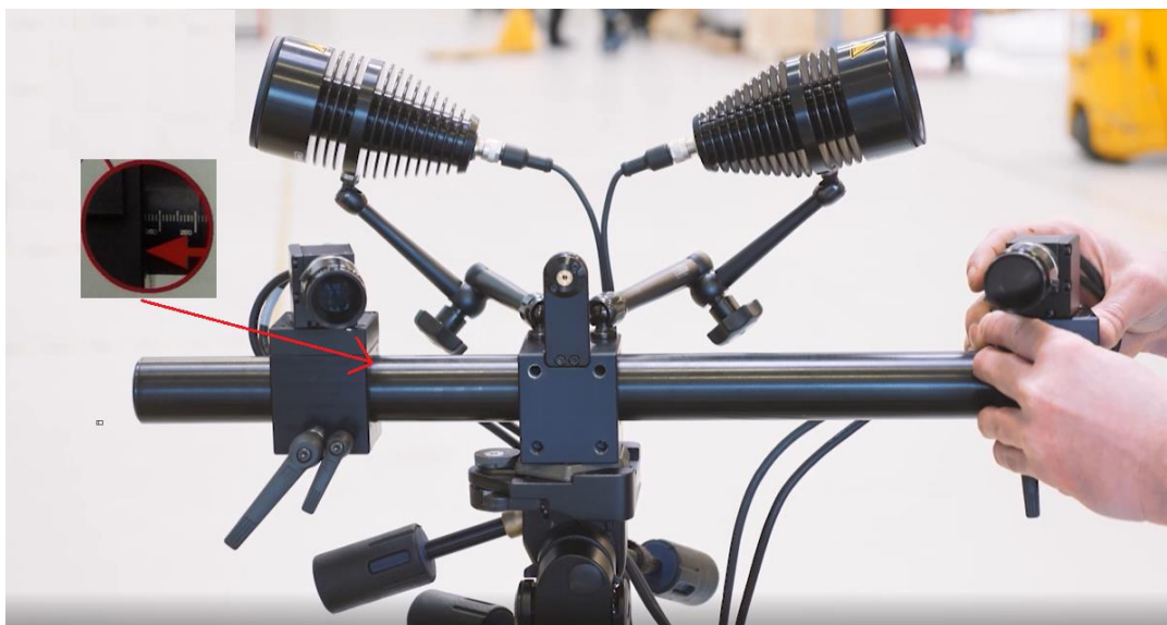
Obrázek 37: Vzájemná poloha kamer se nastavuje pohybem jezdců [45]
