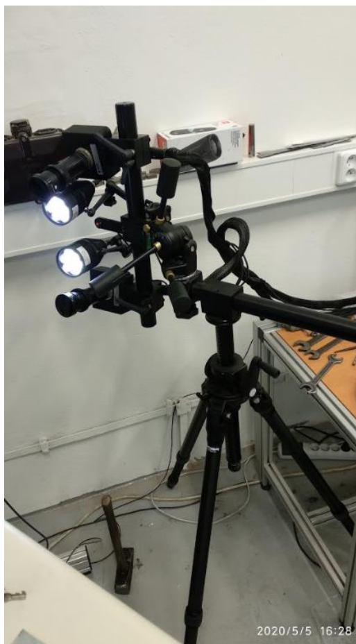
Obrázek 35: Polohovatelný třínohý stativ s namontovaným optickým měřicím systémem ARAMIS 4M
