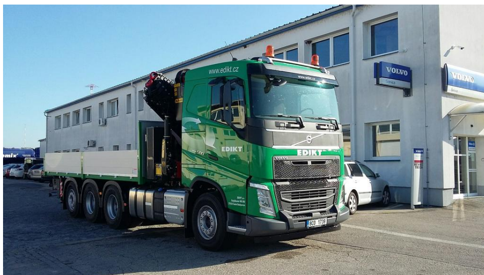
Obrázek 1: Valník s hydraulickou rukou VOLVO FH 8x4 tridem [2]
