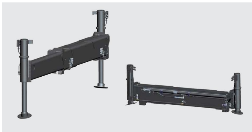
Obrázek 26: Zadní přídavné stabilizační podpěry BS007 [18]
