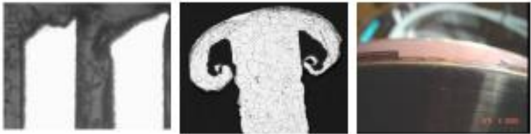
Obrázek 25 Druhy opotřebenění zubů: a) ohýbání, b) zkroucení c) odlomení [74]
