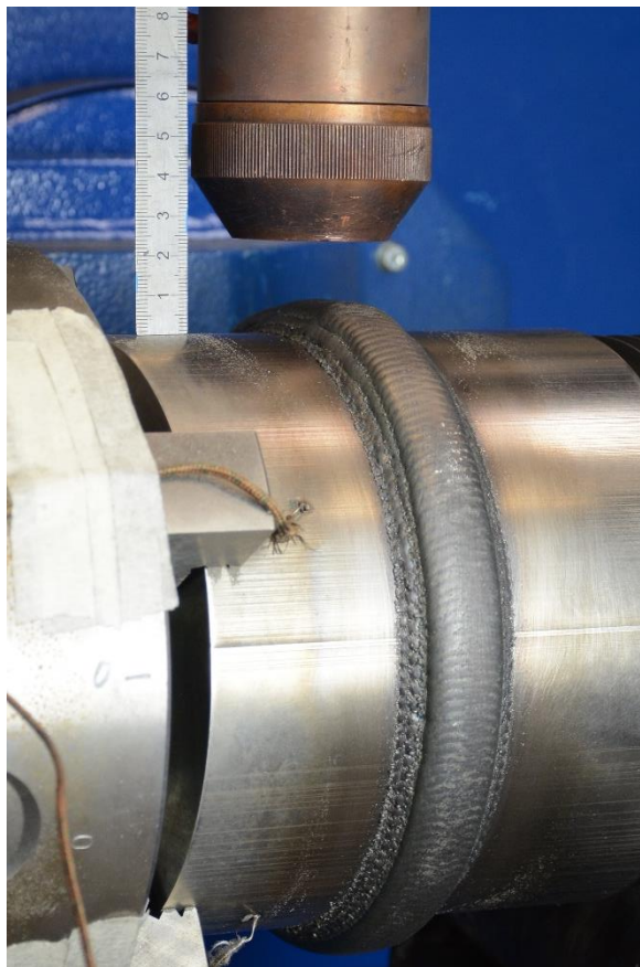
Obrázek 39 Výsledný návar složený z pěti vrstev (prášek Nibasit 625-P)
