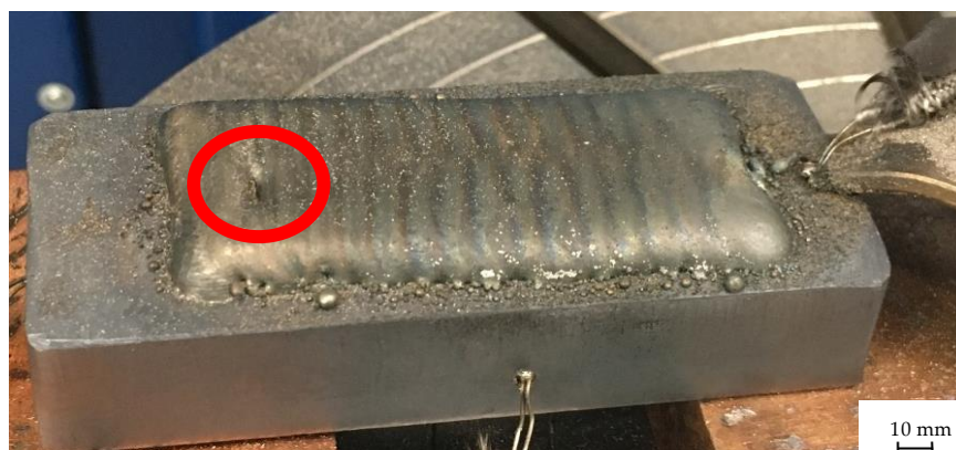
Obrázek 34 První zkušební návar – vznik póru
