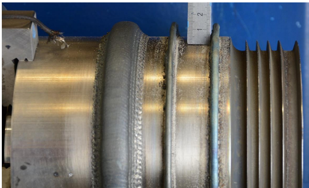
Obrázek 42 Výsledná stěna po navařování (prášek = Celsit V-P)
