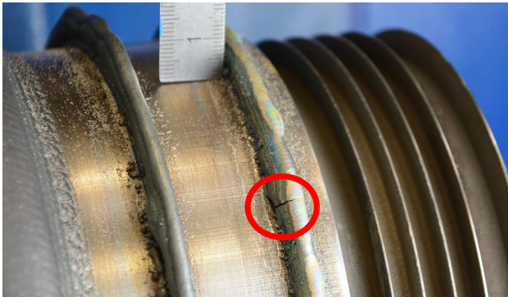
Obrázek 41 Trhlina při navařování 8. vrstvy (prášek = Celsit V-P)
