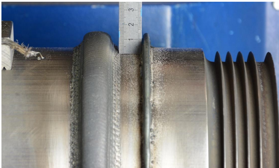
Obrázek 40 Výsledná stěna po navařování (prášek Nibasit 625-P)
