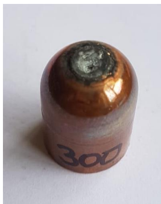
Obr. 29 Horní opotřebovaná čepička HX 300
