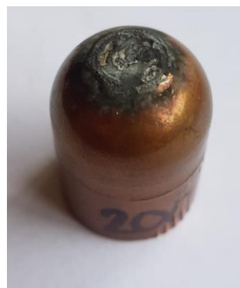
Obr. 28 Horní opotřebovaná čepička HX 200
