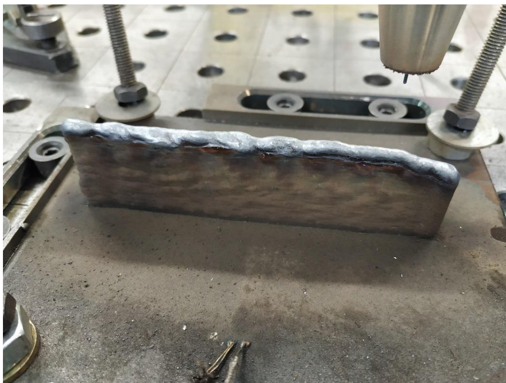
Obr. 21 - Vzorek upevněný na pracovním stole při časové prodlevě po navařeno 19. vrstvy
