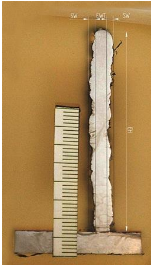
Obr. 35 - Způsob odečítání měřených parametrů [28]
