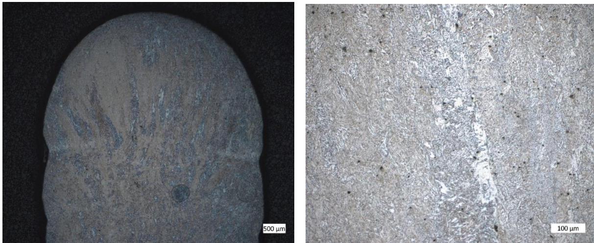
Obr. 34 - Horní část vzorku č. 3 navařeného s teplotou interpass 50 °C a s úpravou návarové plochy před dalším navařením
