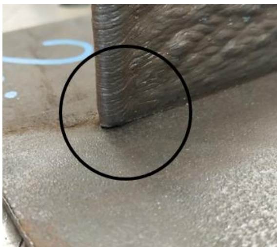
Obr. 23 - Detail vady navaření vzorku č. 2
