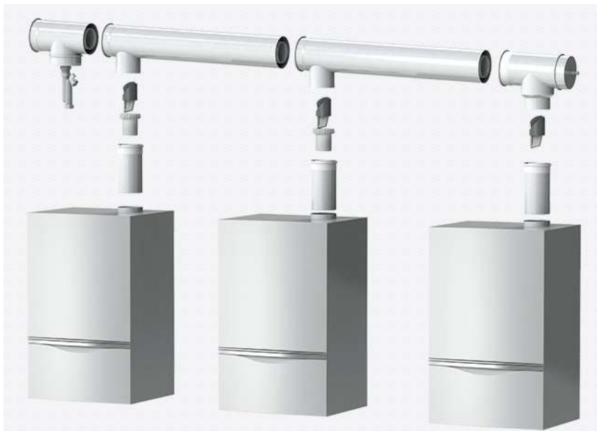
Obr. 1 Schéma koncentrického systému odvodu spalin Almeva CAS [10]
