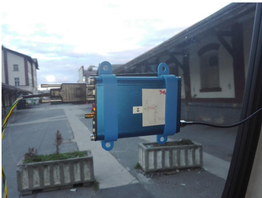
obr. 9 – Umístění jednotky CarScout – pohled zevnitř
