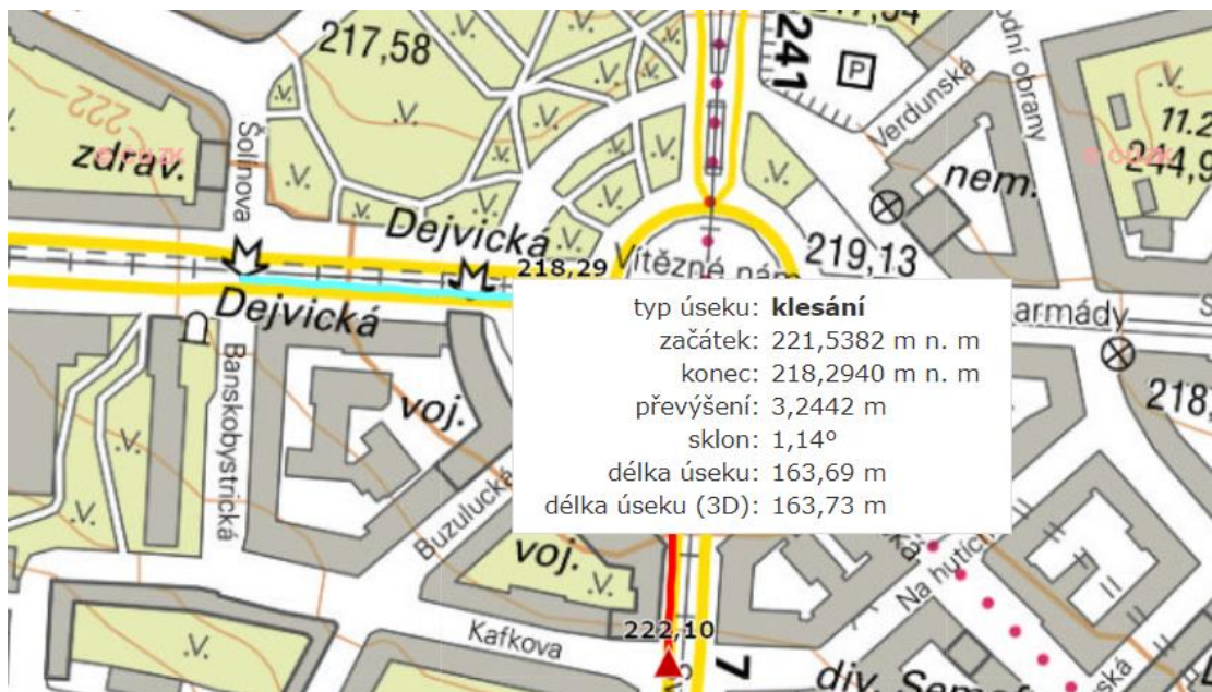
obr. 18 – Zobrazení sklonu trasy v aplikaci „Analýzy výškopisu“
