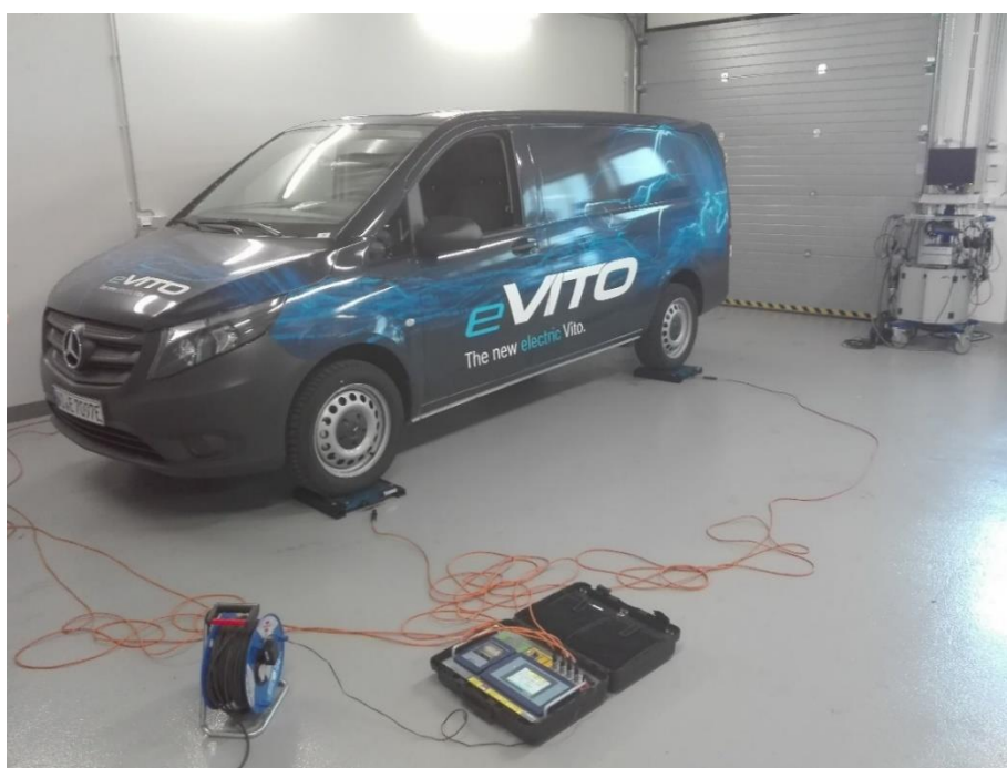
obr. 31 – Vážení dodávky Mercedes-Benz eVito
