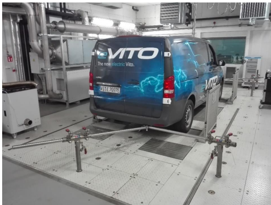
obr. 36 – Testování dodávky eVito na vozidlovém dynamometru
