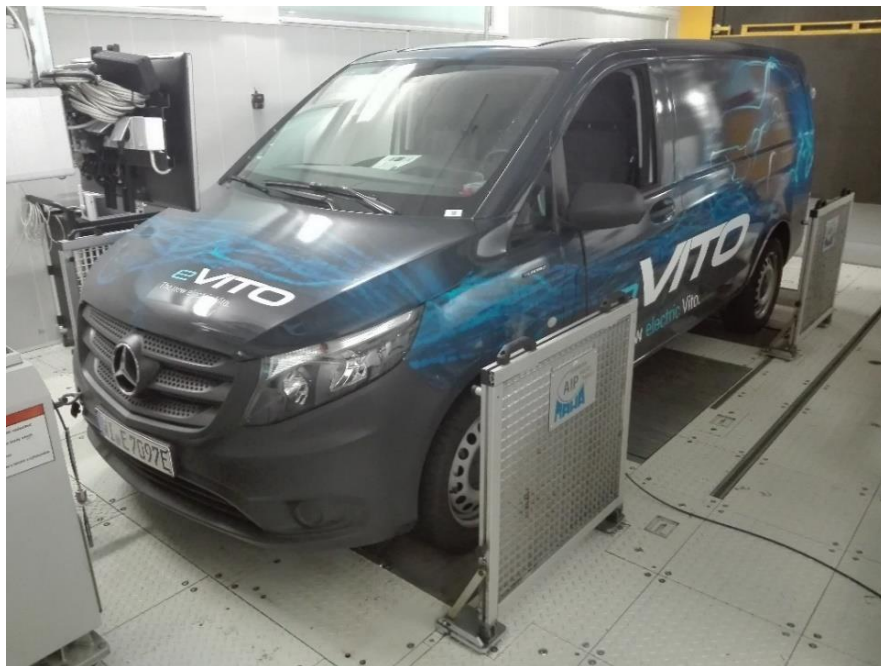
obr. 35 – Testování dodávky eVito vozidlovém dynamometru
