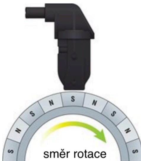
Obrázek 17 Hallův senzor s magnetickým kroužkem [4]
