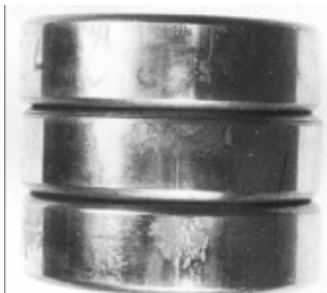
Obrázek 23 Poškození ložiska odíráním [7]
