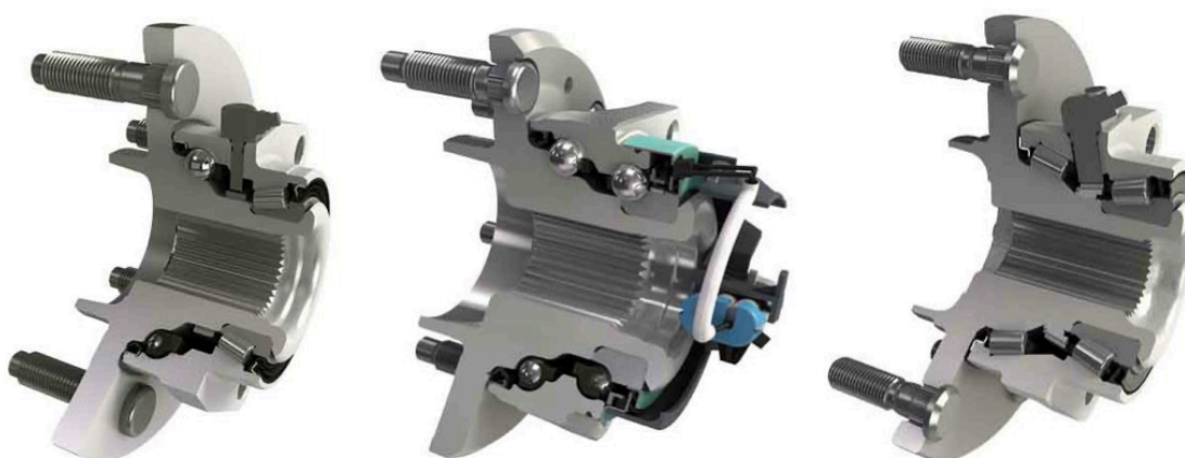
Obrázek 12 Asymetrická a hybridní ložiska. Zleva: kombinace kuliček a kuželíků, rozdílný průměr řad kuliček a kuželíků
