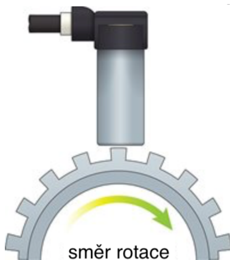
Obrázek 16 Hallův senzor s ozubeným kolem [4]
