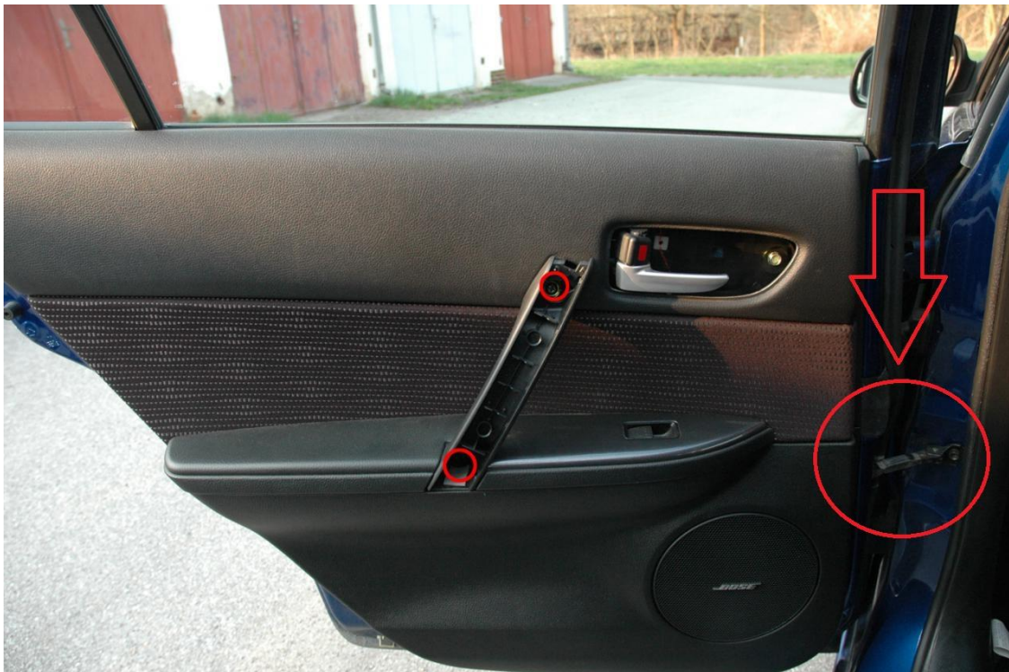
Obr. 9 Umístění klasického stavěče ve dveřích automobilu [12]
