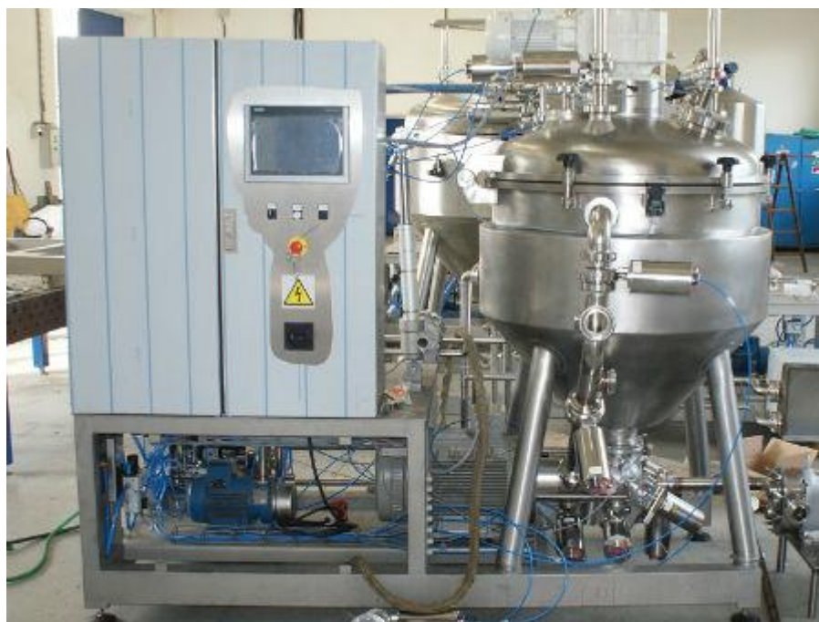
Obr. 2: Míchací zařízení pro homogenizaci majonézy – převzato z Unimont Pacov [5]
