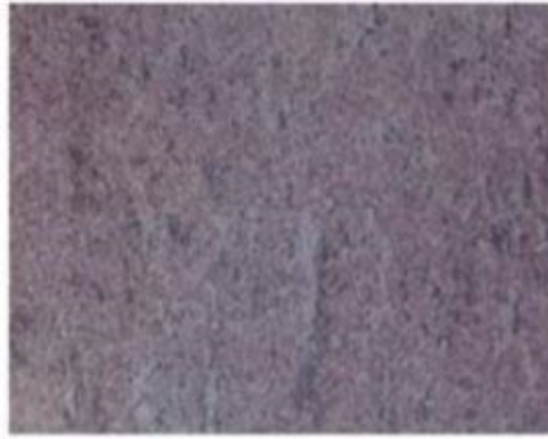
Obrázek 11 B Sa 2 (důkladné otryskání). Písmeno B označuje stupeň zrezivění otryskávaného materiálu [35].
