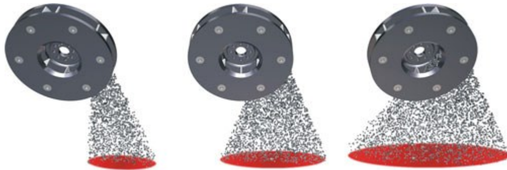
Obrázek 10 Tryskací stopa při různém nastavení rozvaděče abraziva [18]
