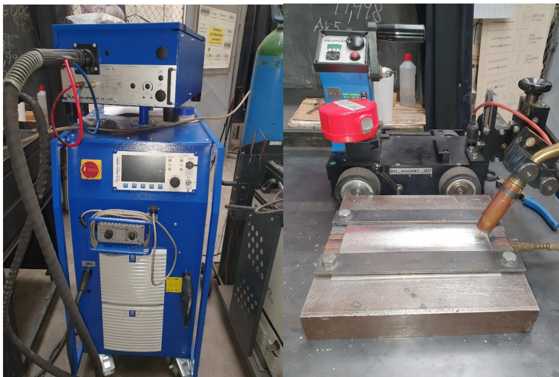
Obrázek 24: Svařovací zdroj Elmatech MIDI MIG (vlevo) a manipulátor Weldycar NV (vpravo).
