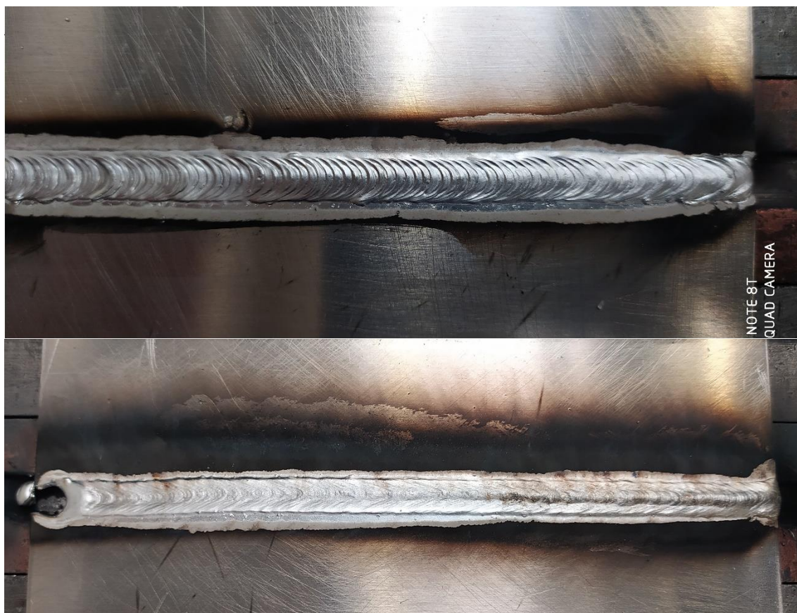
Obrázek 27: Svařené vzorky těsně po svaření, MIG AC (nahore) a MIG DC+ (dole).
