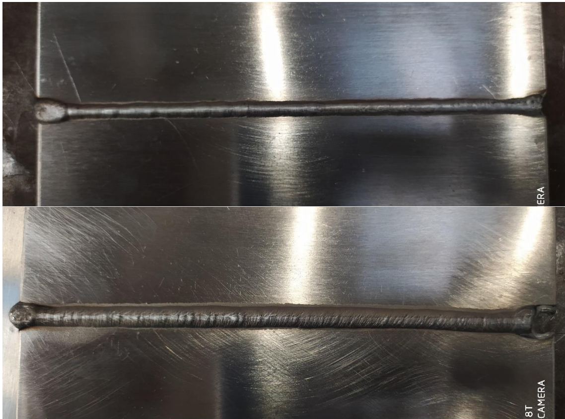
Obrázek 29: Kořen svaru zhotoveného metodou MIG AC (nahore) a MIG DC+ (dole).
