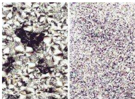
Obr. 3 Krystalická struktura polymeru PP-R a PP-RCT [7]
