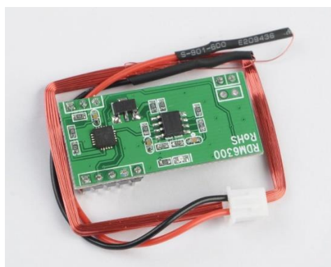
obr. 24 Čtečka pro vlastní naprogramování (Luboš, 2019)
