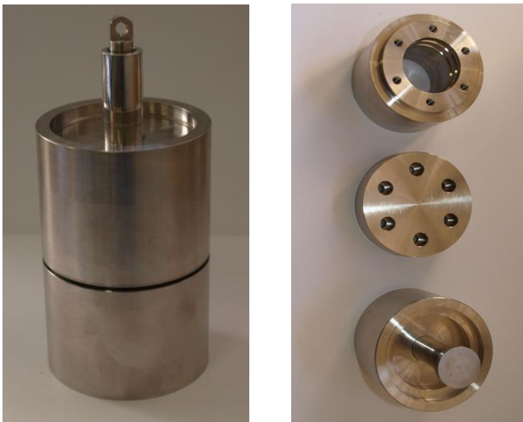
Obr. 25 Přípravek pro měření napětí v normálovém směru
