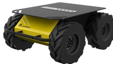
Obrázek 6.2: Husky robot se čtyřkolovým diferenciálním podvozkem. Převzato [26].
