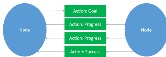
Obrázek 4.3: Diagram komunikace dvou uzlů pomocí actions. Převzato [21].
