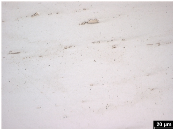
Obr. 25 Podélný řez základního materiálu austenitické oceli Super 304H
