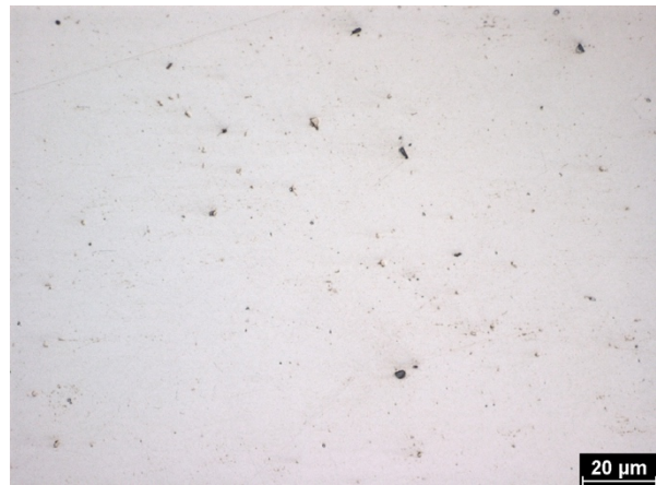
Obr. 26 Příčný řez základního materiálu austenitické oceli Super 304H
