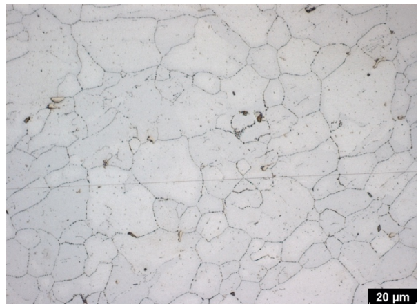
Obr. 30 Sigma fáze na příčném řezu tepelně exponované oceli Super 304H
