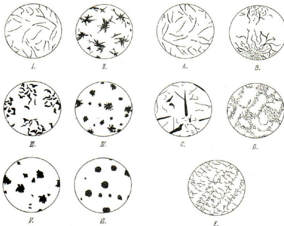
Obrázek 3: Tvar (I. – VI.) a rozložení (A – E) grafitu dle ČSN EN ISO 945 – 1 [2]
