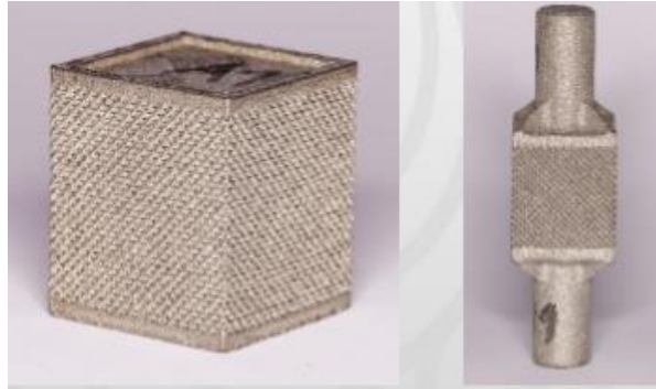
Obr. 28: Vytisknutý vzorek metodou STL. [47]
