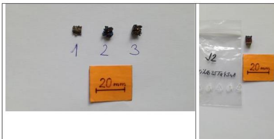
Obr. 33: 3 tištěné vzorky s různým nastavením tiskárny.
