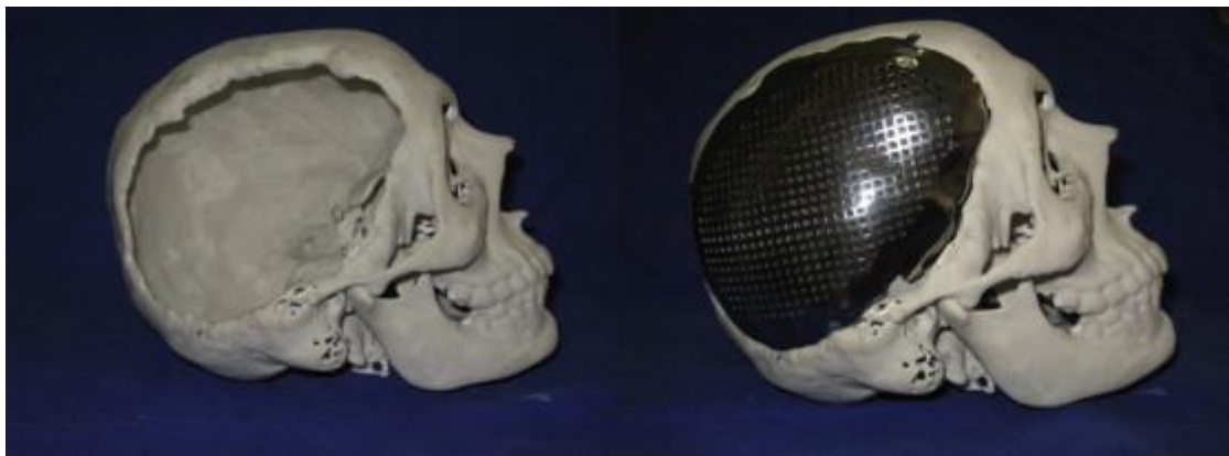
Obr. 13: Část lebky vytištěná metodou DMLS – slitina Ti6Al4V ELI. [28]
