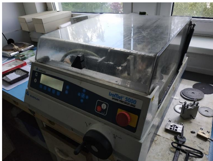
Obrázek P8: Proces řezání vzorků
