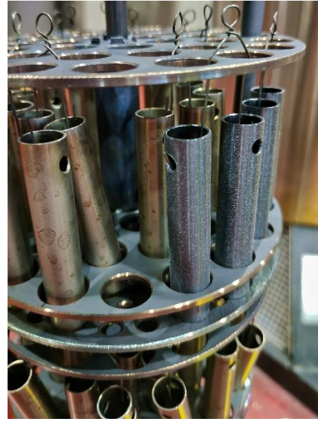
Obrázek 14: Před-oxidované vzorky po vytažení z autoklávu
