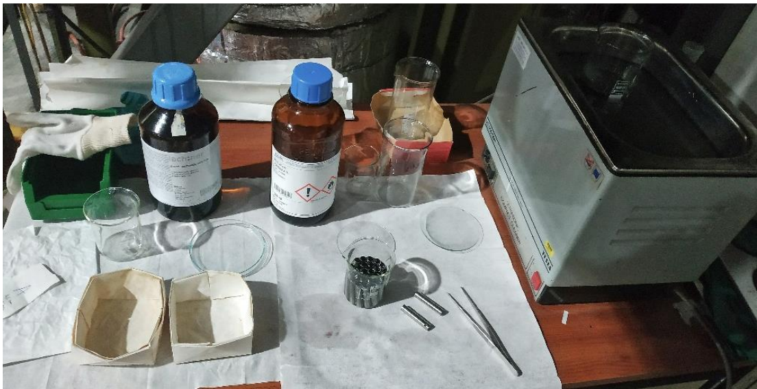
Obrázek P1: Proces odmaštění vzorků v ultrazvuku
