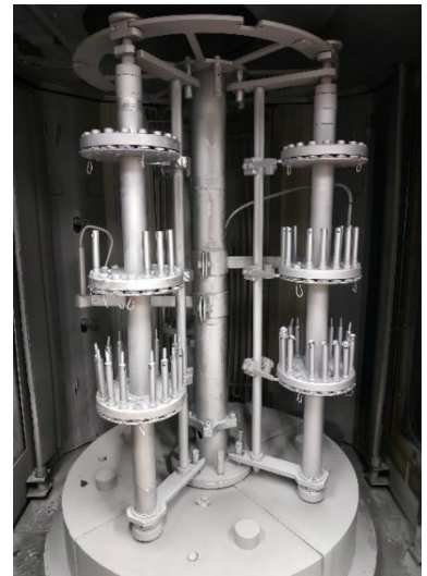
Obrázek 11: Vzorky s již naneseným Cr povlakem
