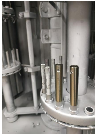
Obrázek 10: Vzorky v přístroji před nanesením povlaku
