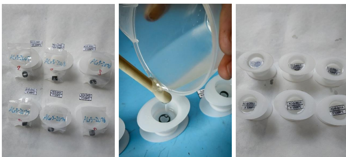
Obrázek P10: Zalévání vzorků do pryskyřice
