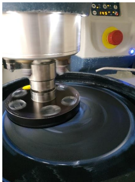
Obrázek P12: Proces leštění
