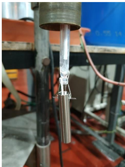
Obrázek 18: Uchycení vzorku skleněnou závlačkou
