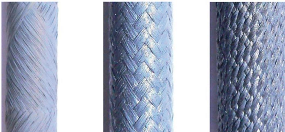
Obrázek 8: Uvažované vláknité struktury SiC/SiC [37]
