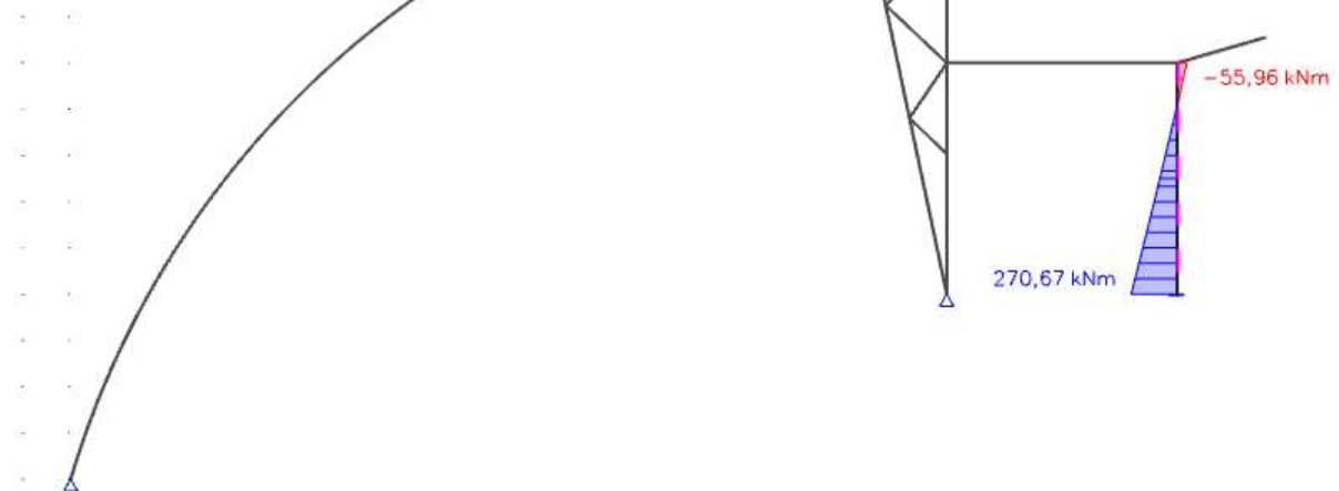
Obr. 18: Průběh ohybového momentu na sloupu – KZS 324
