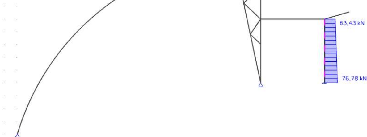
Obr. 20: Průběh posouvající síly na sloupu – KZS 540
