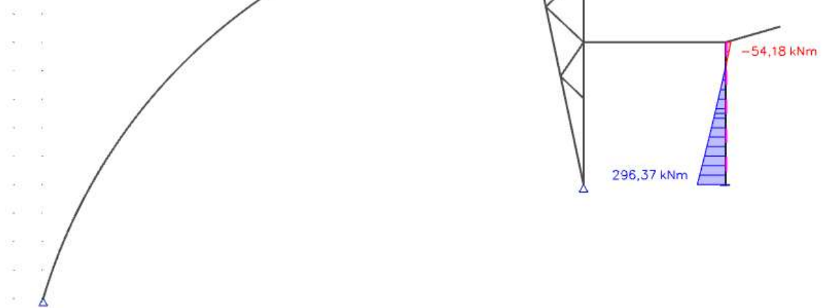
Obr. 16: Průběh ohybového momentu na sloupu – KZS 540
