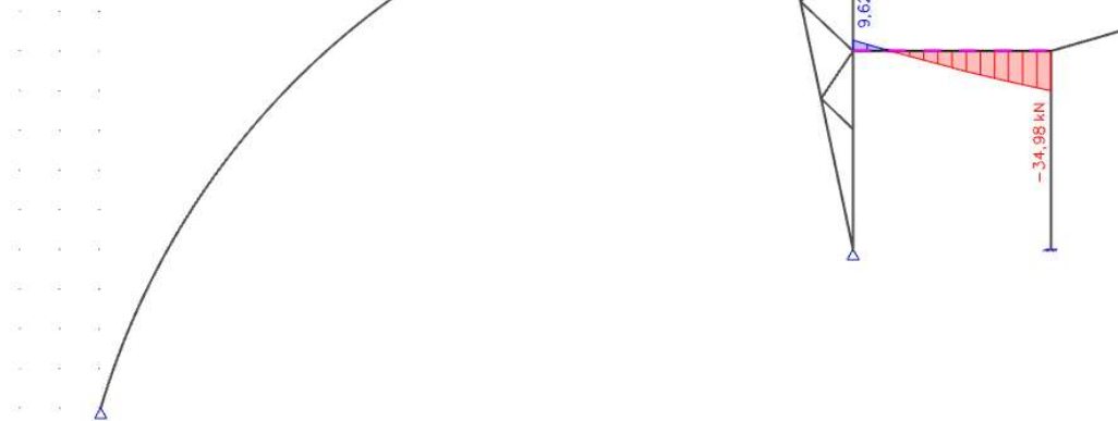
Obr. 26: Průběh posouvající síly na nosníku – KZS 324
