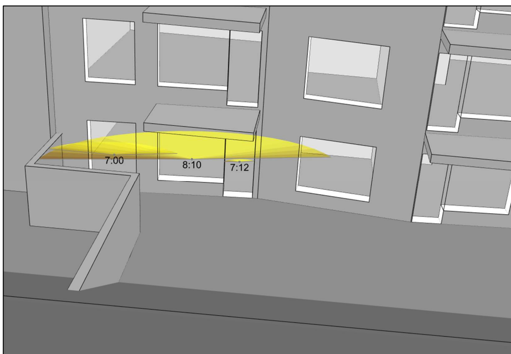
Obr. 10: Doba proslunění v místnosti 1.18 dle ČSN 73 4103, výstup z programu BuildingDesign
