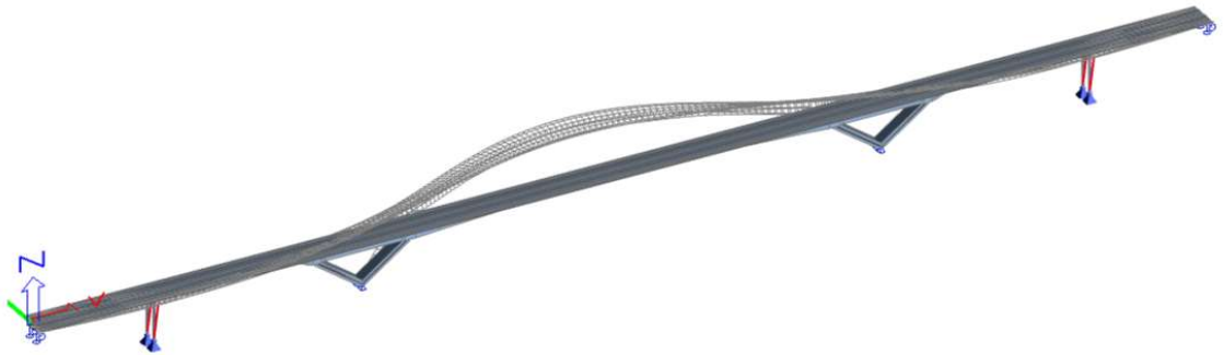
Obrázek 218 - Pohled na 3. vl. tvar ( f=1,28 Hz)
