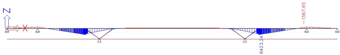
Obrázek 174 - Průběh ohybových momentů při oteplení konstrukce
