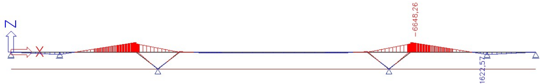
Obrázek 175 - Průběh ohybových momentů při ochlazení konstrukce
