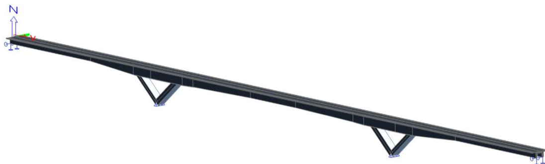
Obrázek 320 - Pohled na deskostěnový model
