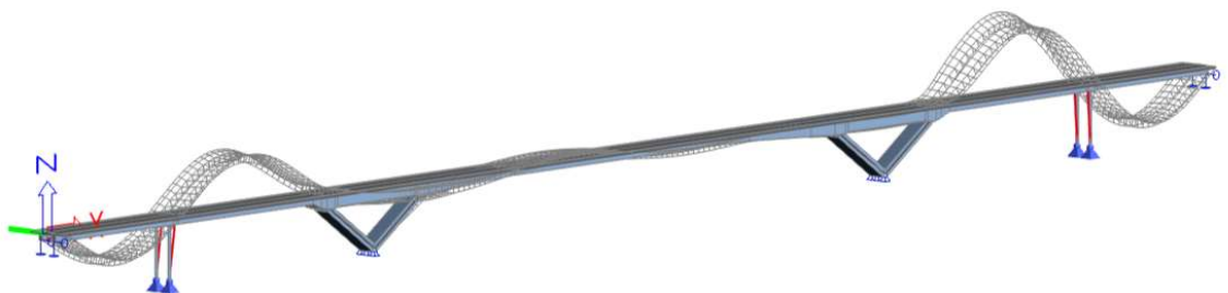
Obrázek 220 - Pohled na 9. vl. tvar ( f=2,91 Hz)
