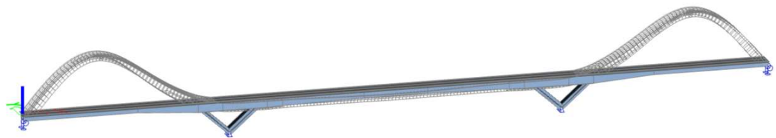
Obrázek 323 - Pohled na 4. vl. tvar ( f=1,74 Hz)
