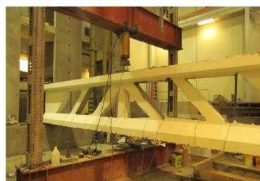
Obr. 7 - Zatěžovací zkouška nosníku [20]
