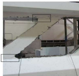
Obr. 10 - Porušení a plastizace kloubů [20]
