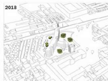
Cauta e Prevedente Demolizione Gli elementi architettonici utilizzabili vengono demoliti e messi da parte. Le parti principali delle facciate vengono demolite. Le massicce trabe di accesso e il pezzo dell'ala nord rimangono. Le materie vengono polverizzate, separate e ammassate in colline temporanee a formare un paesaggio temporaneo (preparato).
