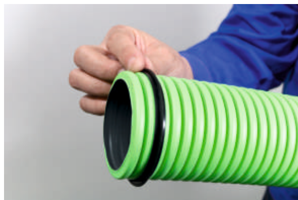
2) Do 2. nebo 3. drážky nasadíme těsnící kroužek.
