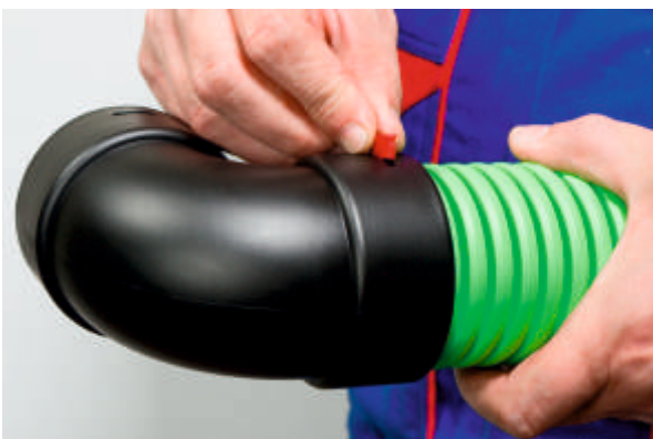
7) Otvory pro pojistky vystředíme vůči drážce v trubce a zasuneme obě pojistky do max. hloubky.
