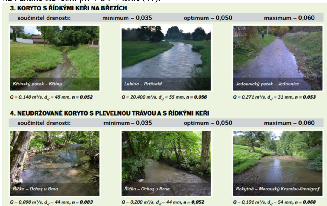
Obrázek 51 – Fotografický katalog drsnosti
