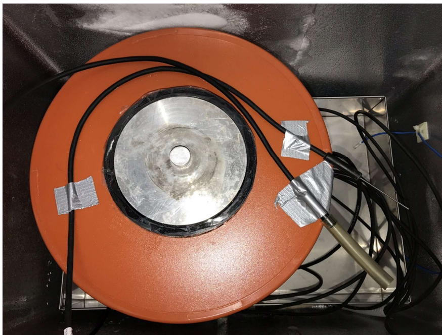
Obrázek 12: Detail umístění teplotního čidla č. 6 a 7
