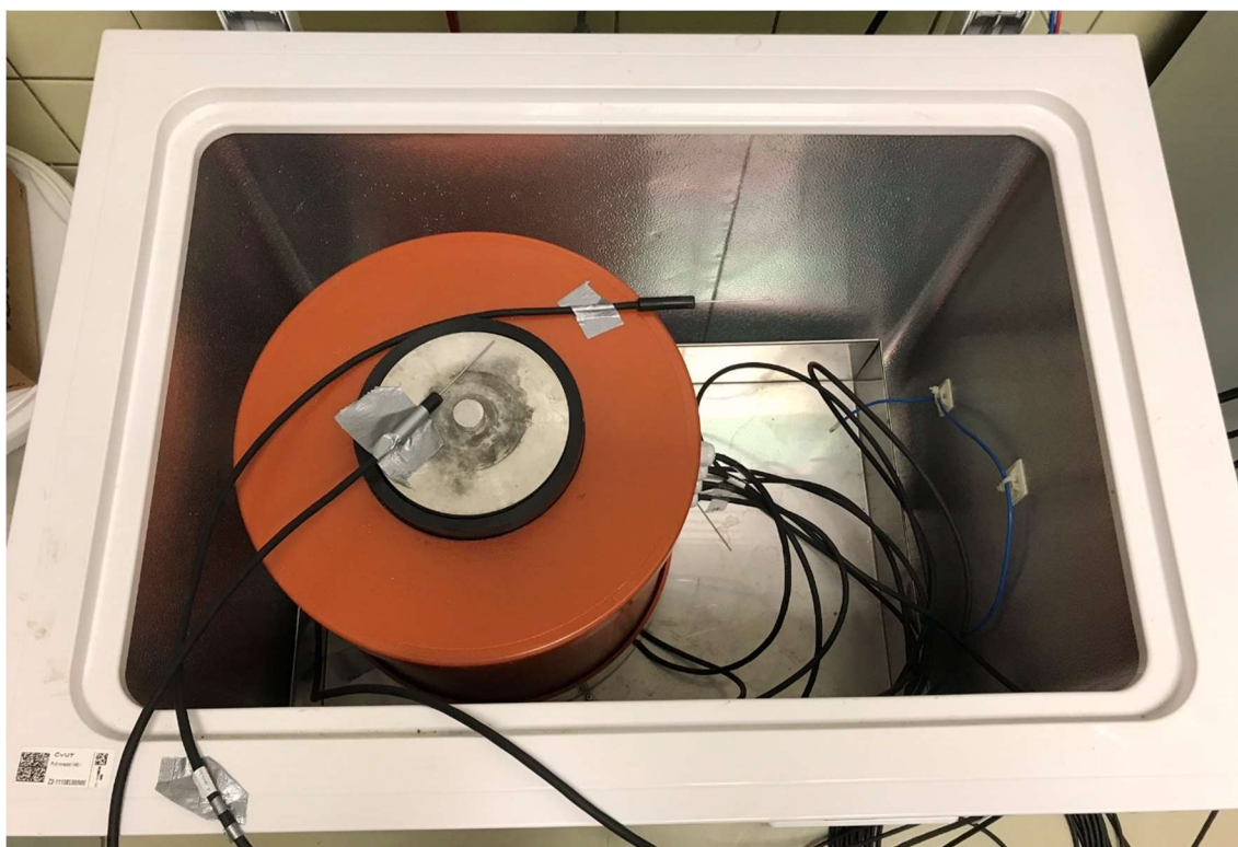
Obrázek 5: Experimentální válcová sestava umístěná v mrazící jednotce
