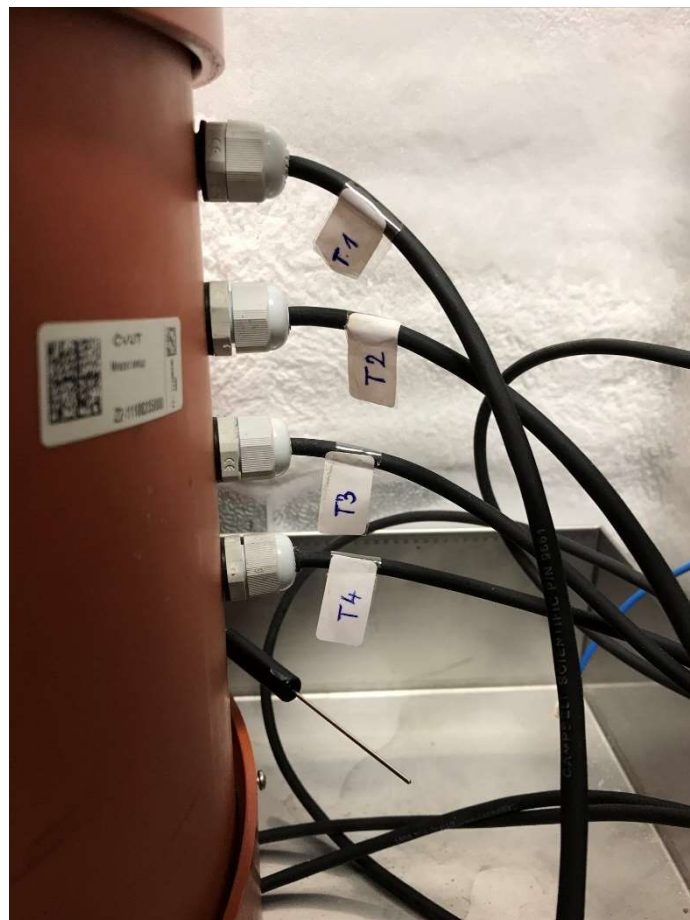
Obrázek 7: Detail umístění vývodek na vnější straně válce
