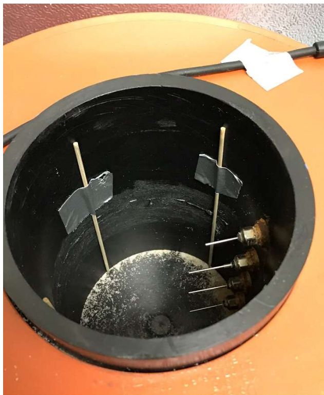
Obrázek 10: Detail umístění dřevěných podpěr ve vzorku se vzduchem
