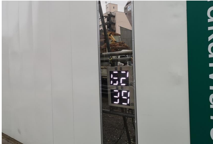
Obrázek 60: Neustáé měření hluku v rámci staveniště [archiv autora]
