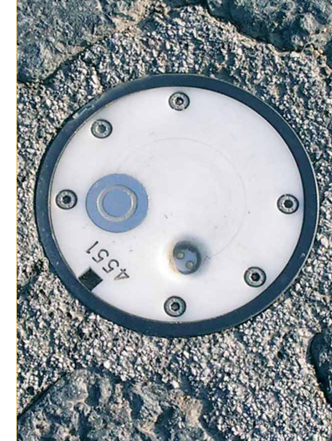
Ukázka silniční meteorologické stanice vybavené větroměrnými čidly; silniční senzor je zapuštěn ve vozovce.
