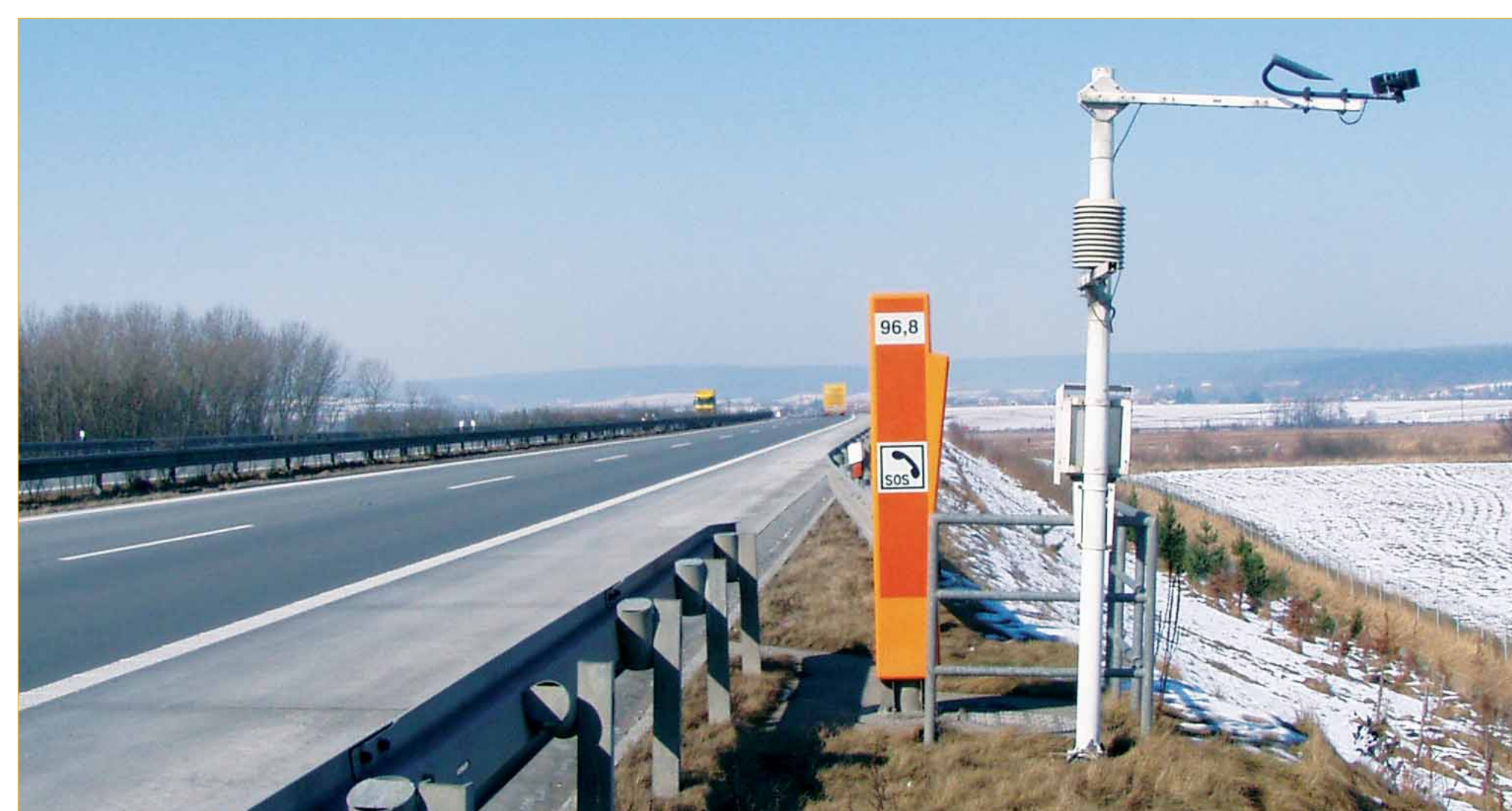
Ukázka silniční meteorologické stanice vybavené větroměrnými čidly; silniční senzor je zapuštěn ve vozovce.
