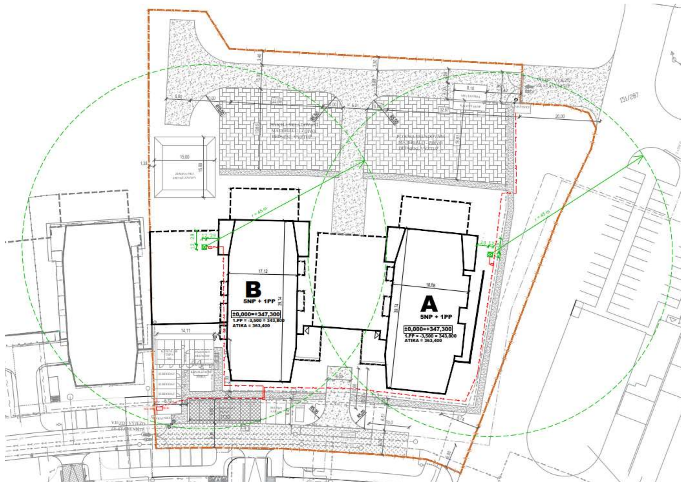
Obrázek 7: Situace - Dva věžové jeřáby
