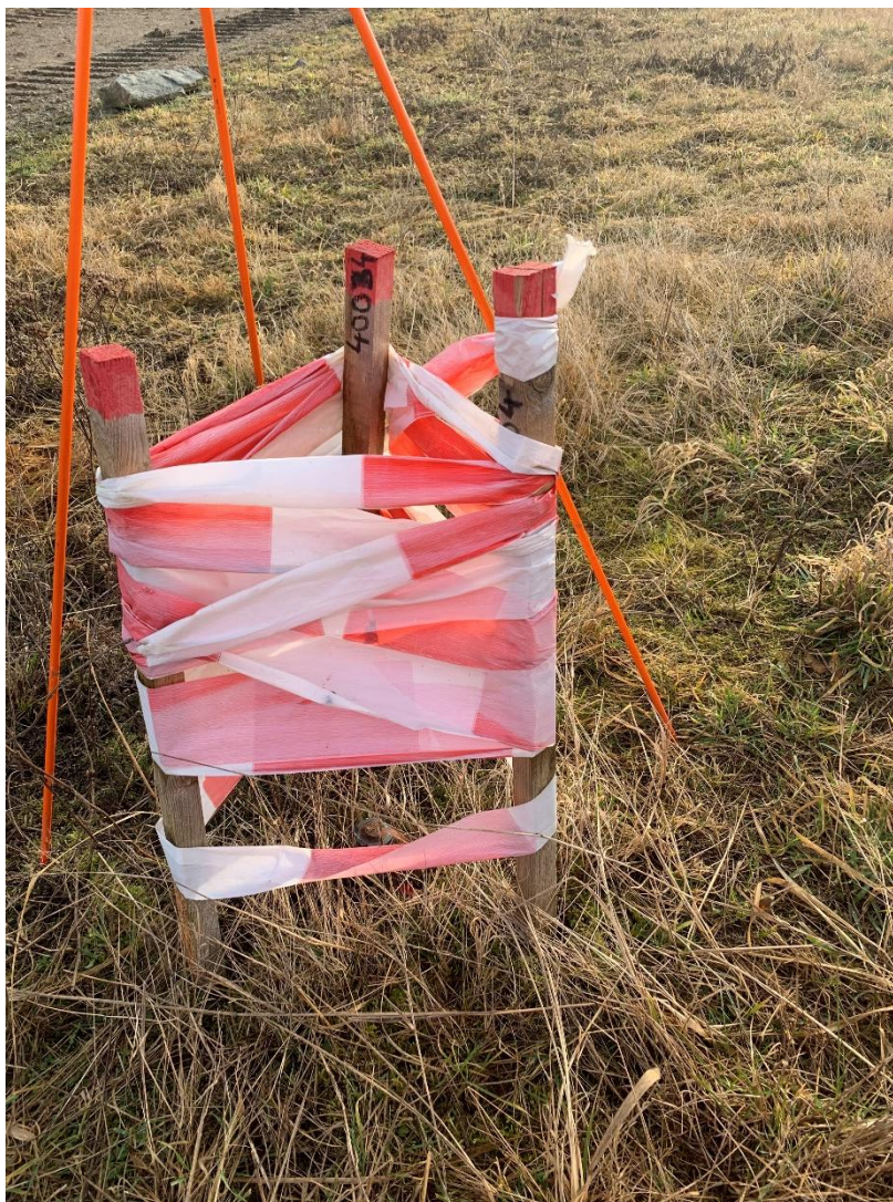
Obr. 4 - Stabilizace bodů primární sítě a jeho ochranné pásmo
