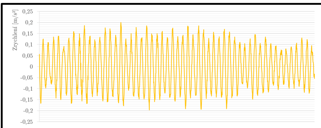
Obr. 42 Detail záznamu č. 1 dlouhý 5 s, ze kterého byla vyhodnocena maximální RMS hodnota zrychlení
