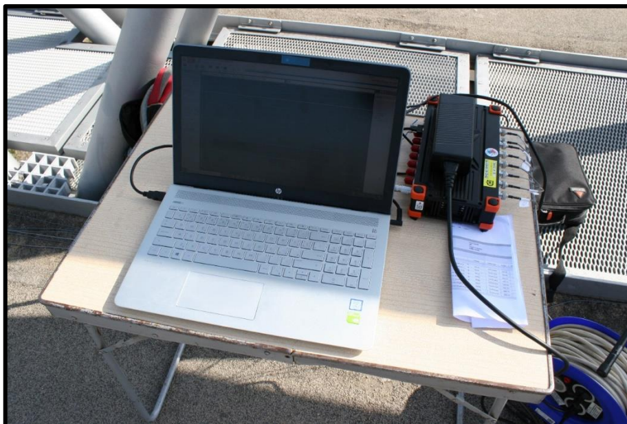
Obr. 19 Měřicí ústředna SIRIUS připojená k ovládacímu počítači
