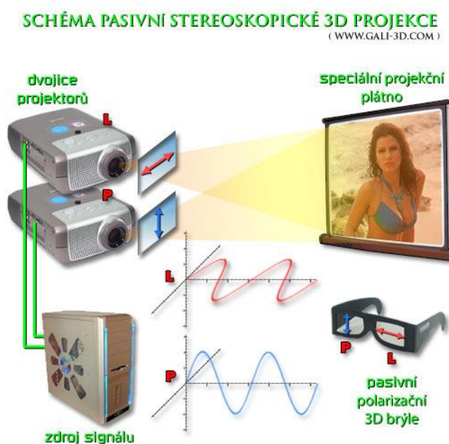
Obr. 4: Pasivní 3D technologie [6]
