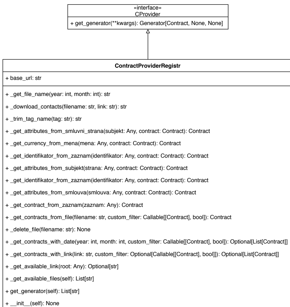
Obrázek 3.3: Diagram tříd - CProvider
