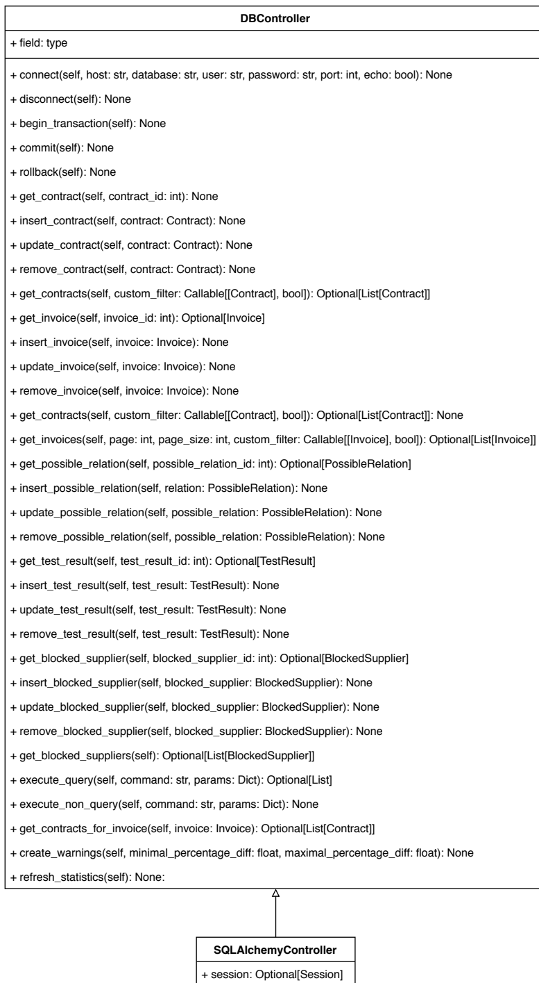
Obrázek 3.4: Diagram tříd - DBController
