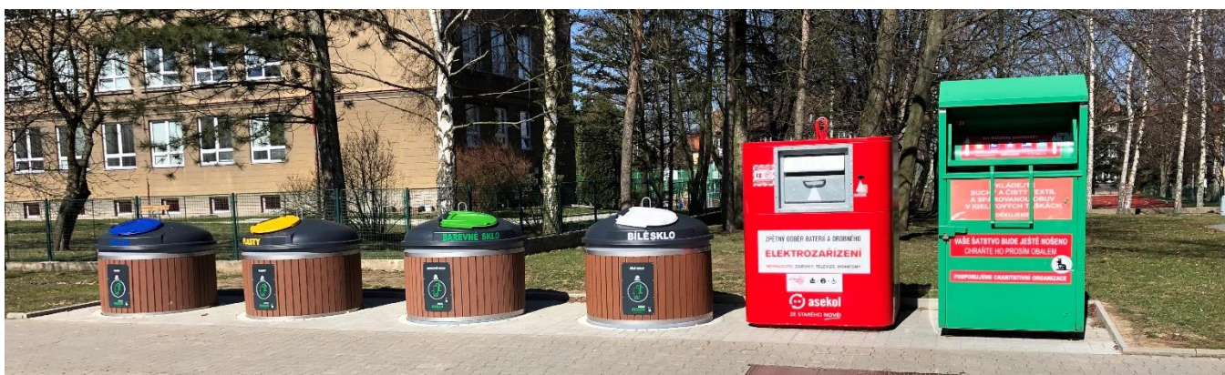
Obrázek 29 – polo podzemní kontejnery
