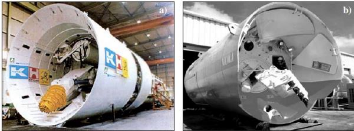
Obrázek 20 a) Štít s postupným pobíráním v čelbě opatřen výložníkovou frézou b) Štít s postupným pobíráním s tlakově podepřenou čelbou s „tunnelbagrem“ a částečným mechanickým pažením. [5]
